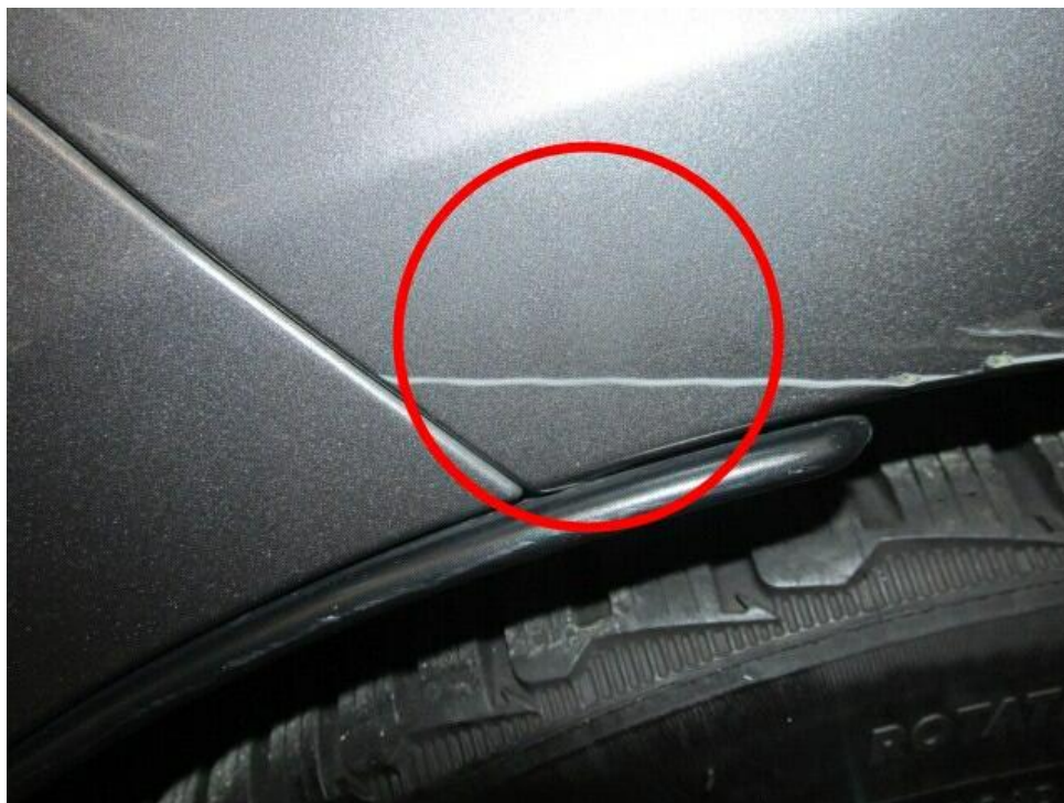
Bild 16 : Seitenwand hinten rechts deformiert /Türe hinten rechts verschrammt
