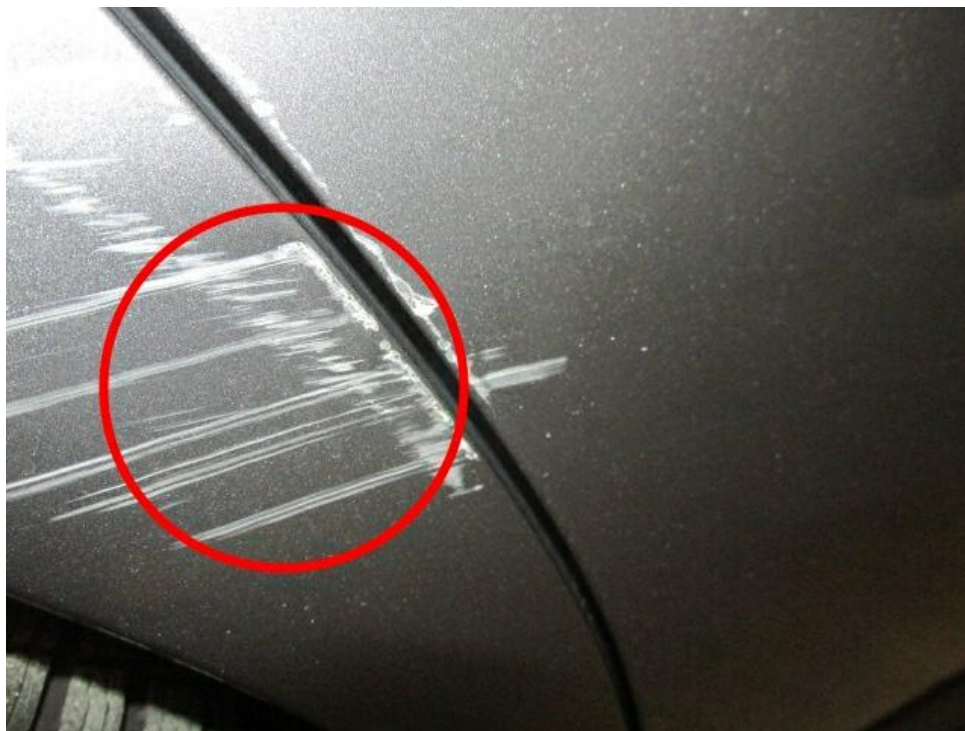
Bild 15 : Seitenwand hinten rechts deformiert /Türe hinten rechts verschrammt
