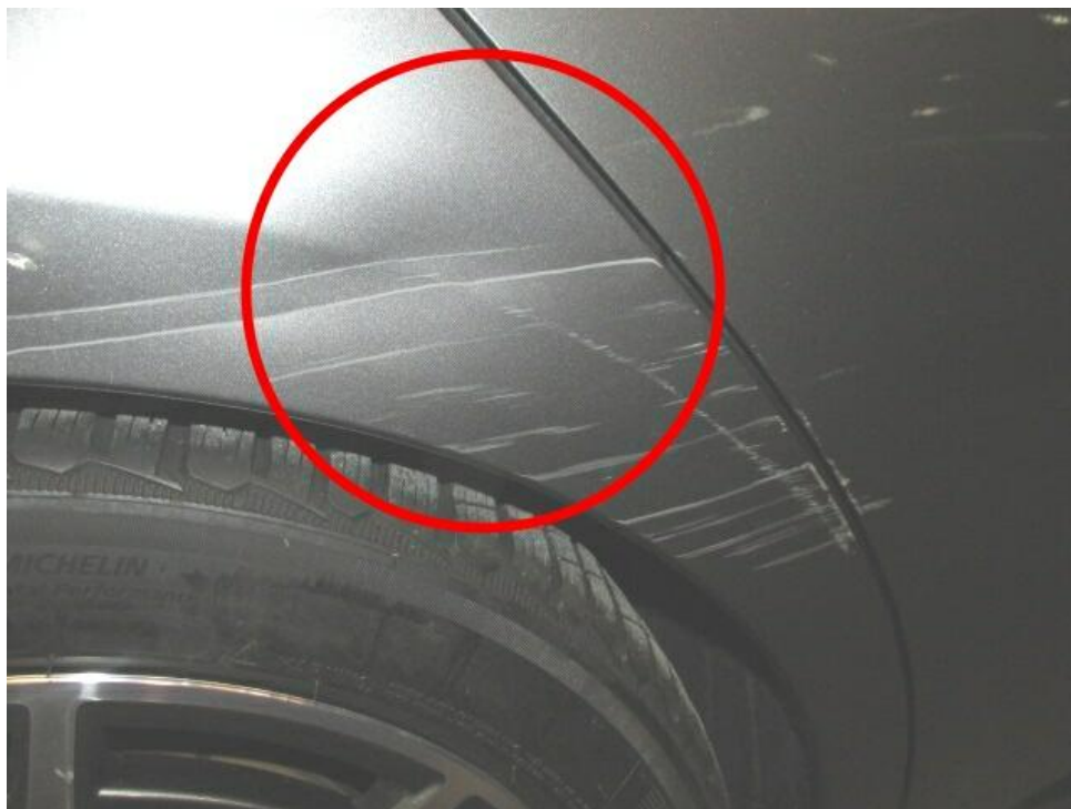
Bild 14 : Seitenwand hinten rechts deformiert /Türe hinten rechts verschrammt
