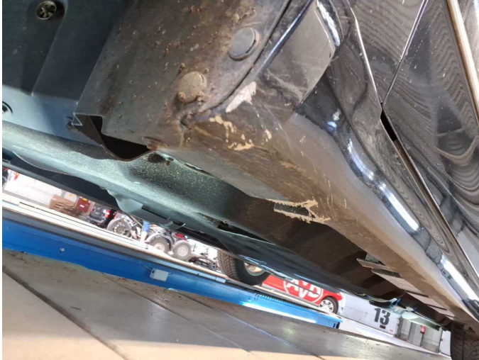
Damage 12: Sill - left side: Sill (Verkleidung) - Scratched - Replace
