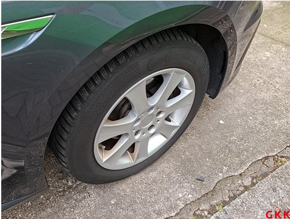
Bild 21. LM-Rad, vorne rechts, verkratzt, Smartrepair
