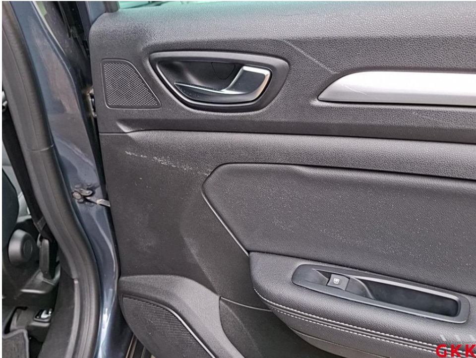
Bild 23. Tür hinten rechts, Innenverkleidung -Standard-, beschädigt, Smartrepair
