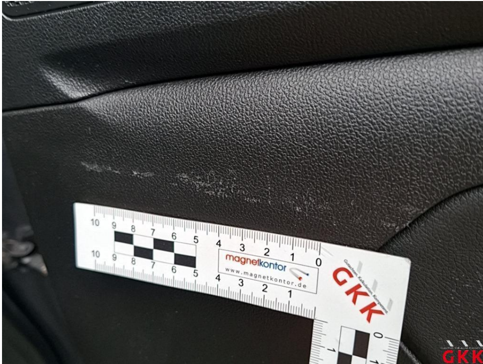
Bild 25. Tür hinten rechts, Innenverkleidung -Standard-, beschädigt, Smartrepair
