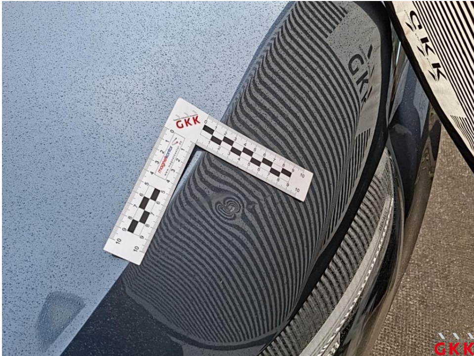
Bild 13. Motorhaube, beschädigt, instand setzen - lackieren
