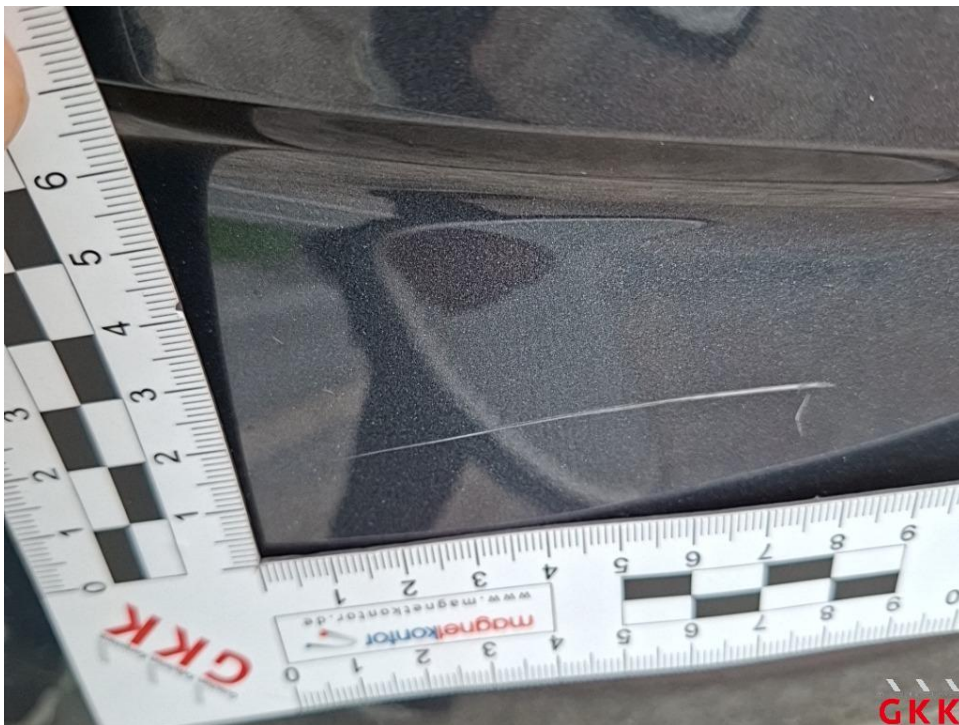
Bild 20. Stoßfänger hinten, Verkleidung -lackiert-, verkratzt, Smartrepair
