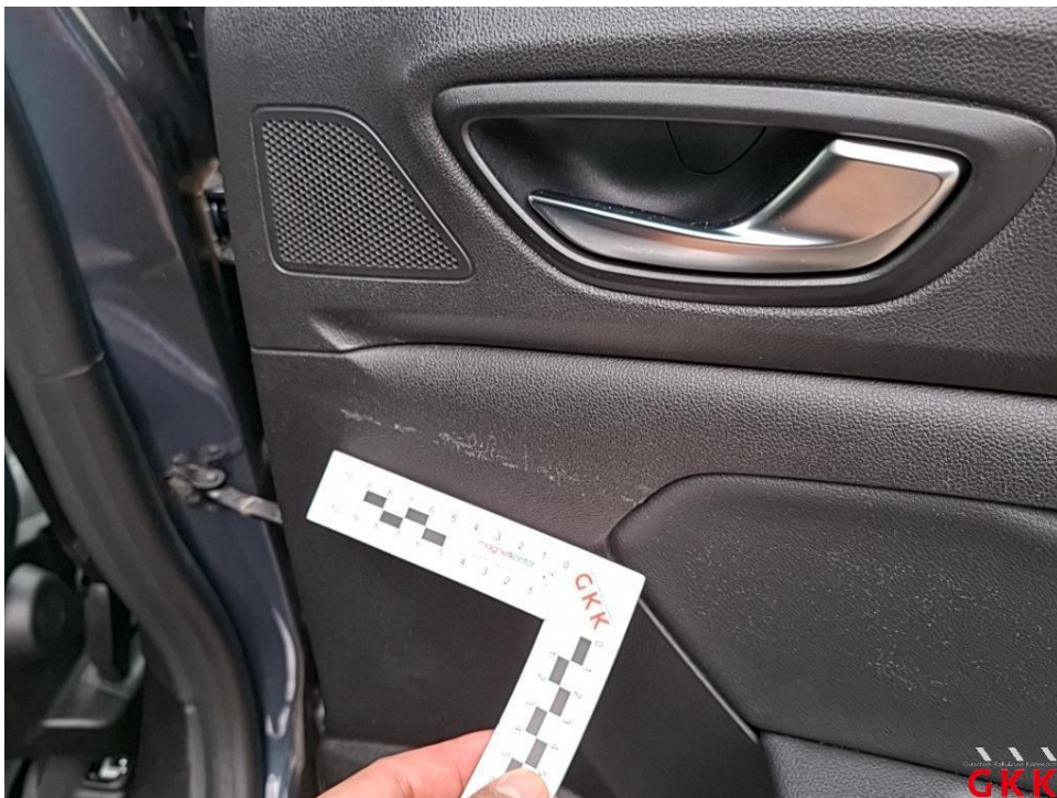
Bild 24. Tür hinten rechts, Innenverkleidung -Standard-, beschädigt, Smartrepair
