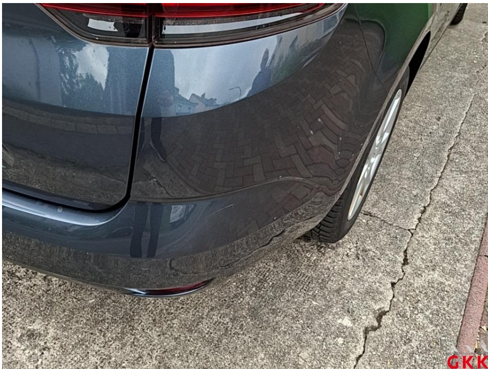
Bild 18. Stoßfänger hinten, Verkleidung -lackiert-, verkratzt, Smartrepair
