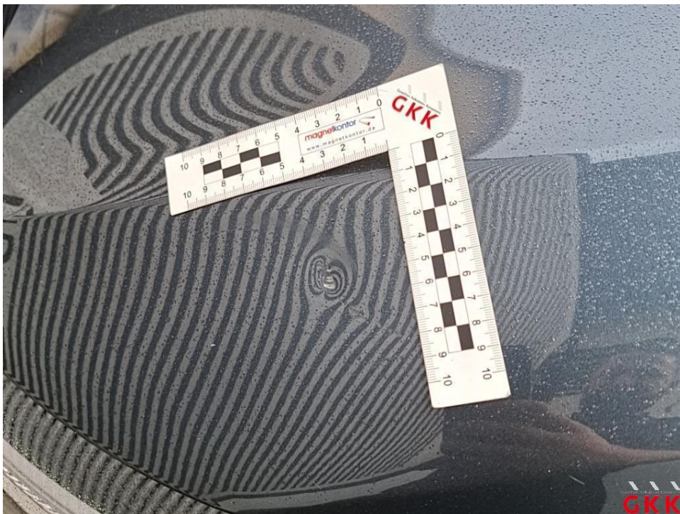
Bild 14. Motorhaube, beschädigt, instand setzen - lackieren
