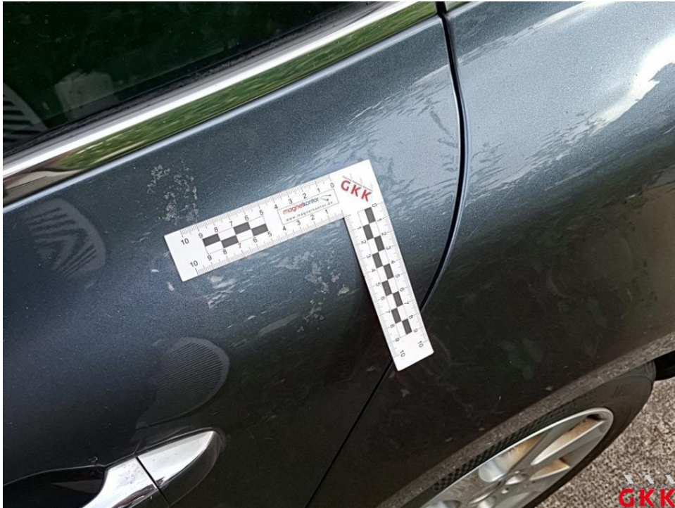
Bild 15. Tür hinten links, Harzanhaftungen/-rückstände, aufbereiten
