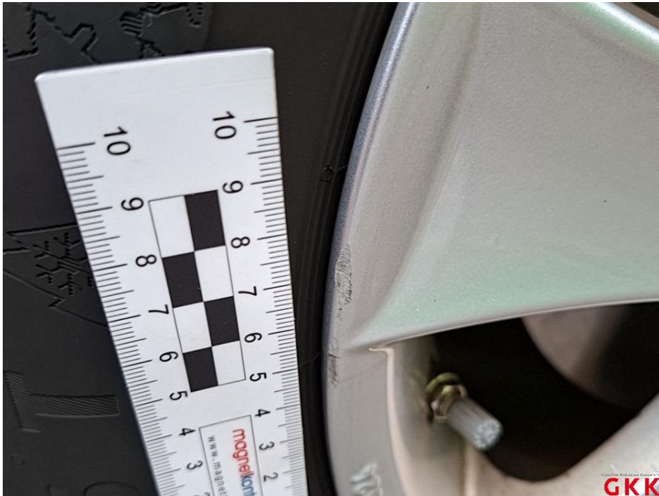
Bild 22. LM-Rad, vorne rechts, verkratzt, Smartrepair
