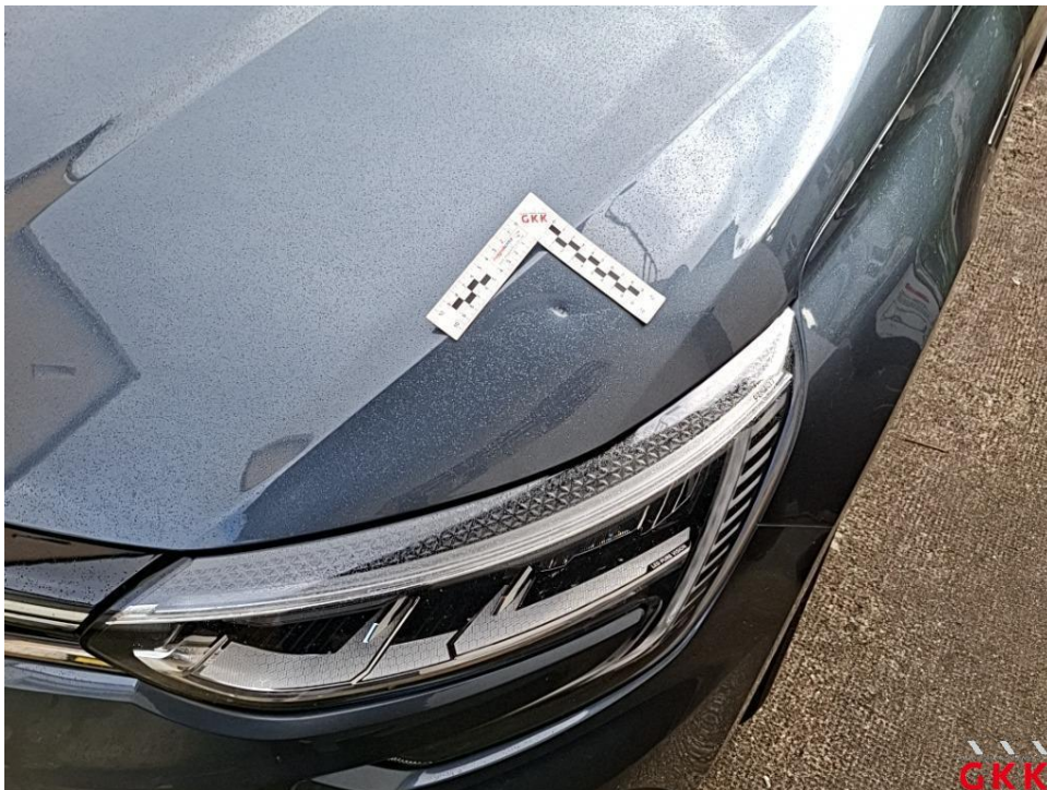
Bild 12. Motorhaube, beschädigt, instand setzen - lackieren
