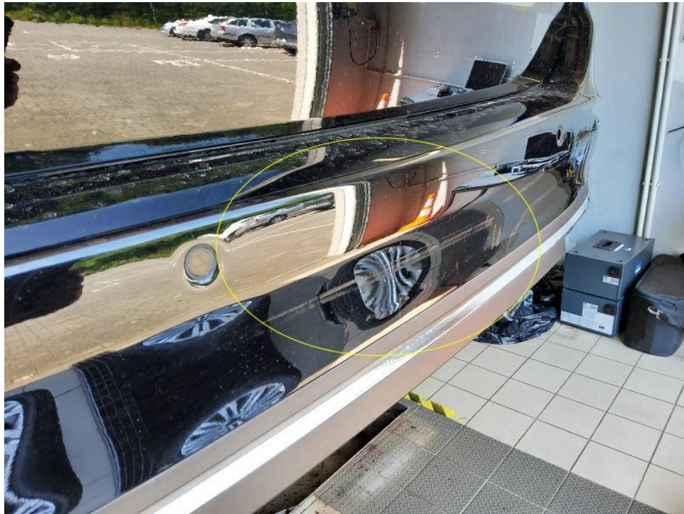
Bild 19 : Heckstoßfängerverkleidung rechts verschrammt und gebrochen - Unfallschaden
