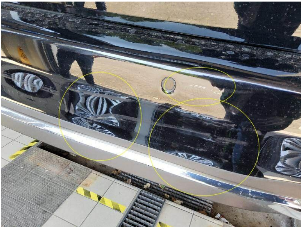
Bild 18 : Heckstoßfängerverkleidung rechts verschrammt und gebrochen - Unfallschaden
