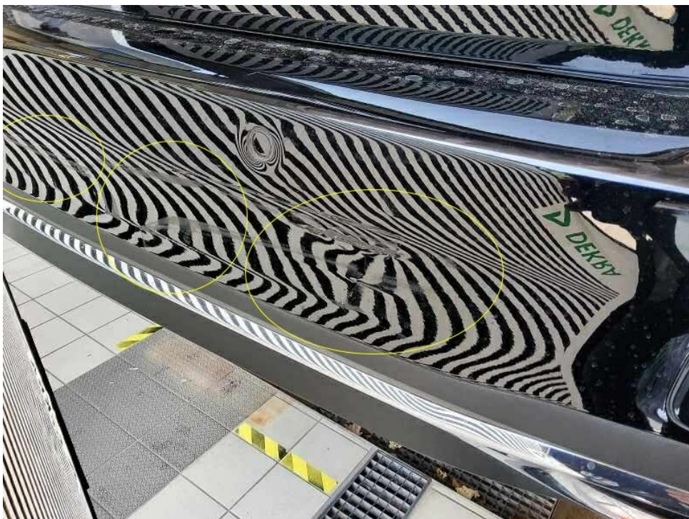
Bild 22 : Heckstoßfängerverkleidung rechts verschrammt und gebrochen - Unfallschaden
