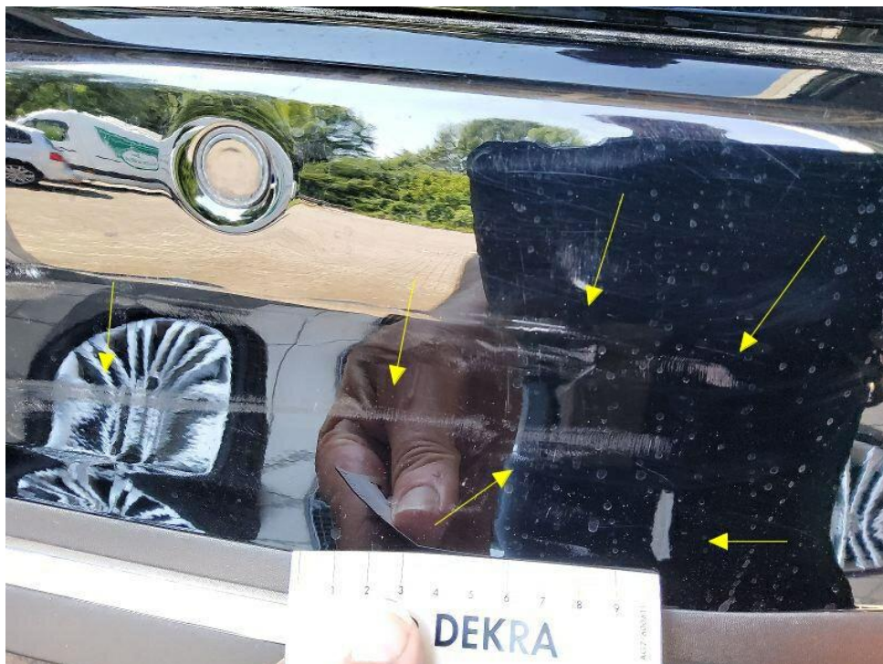
Bild 20 : Heckstoßfängerverkleidung rechts verschrammt und gebrochen - Unfallschaden
