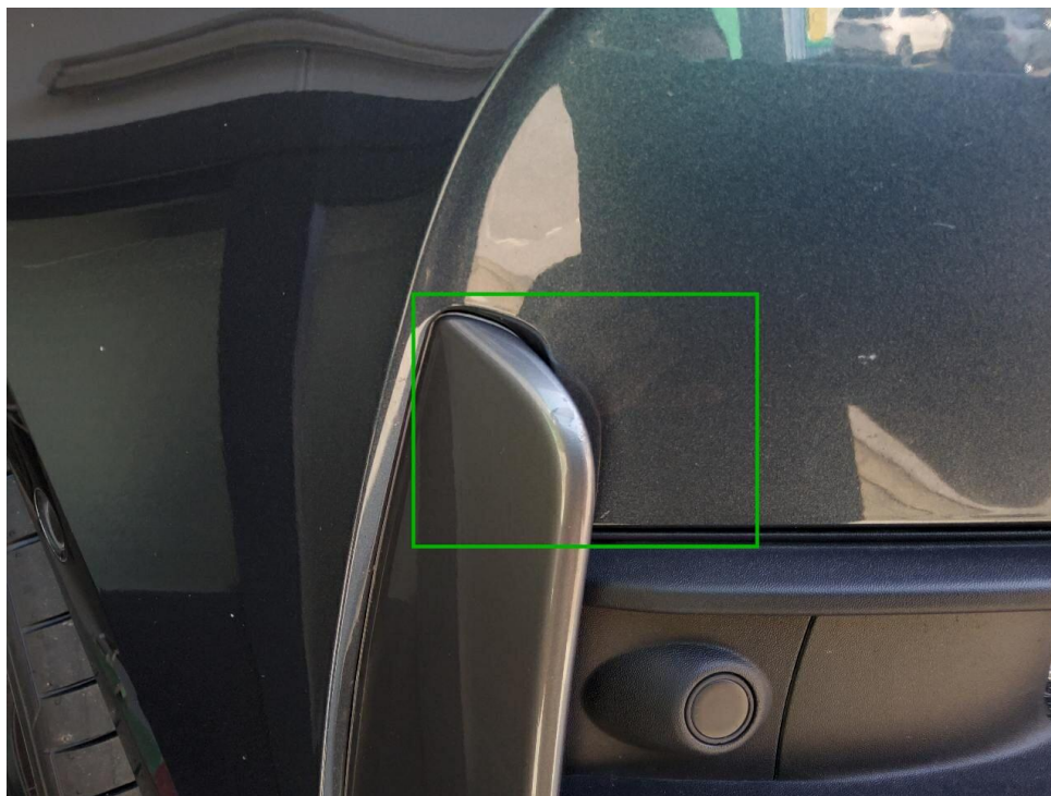
Bild 15 : Stoßfänger vorne rechts, verschrammt
