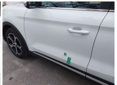
Porte / Avant Gauche / Enfoncement
