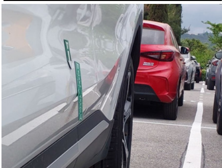
Porte / Avant Gauche / Enfoncement
