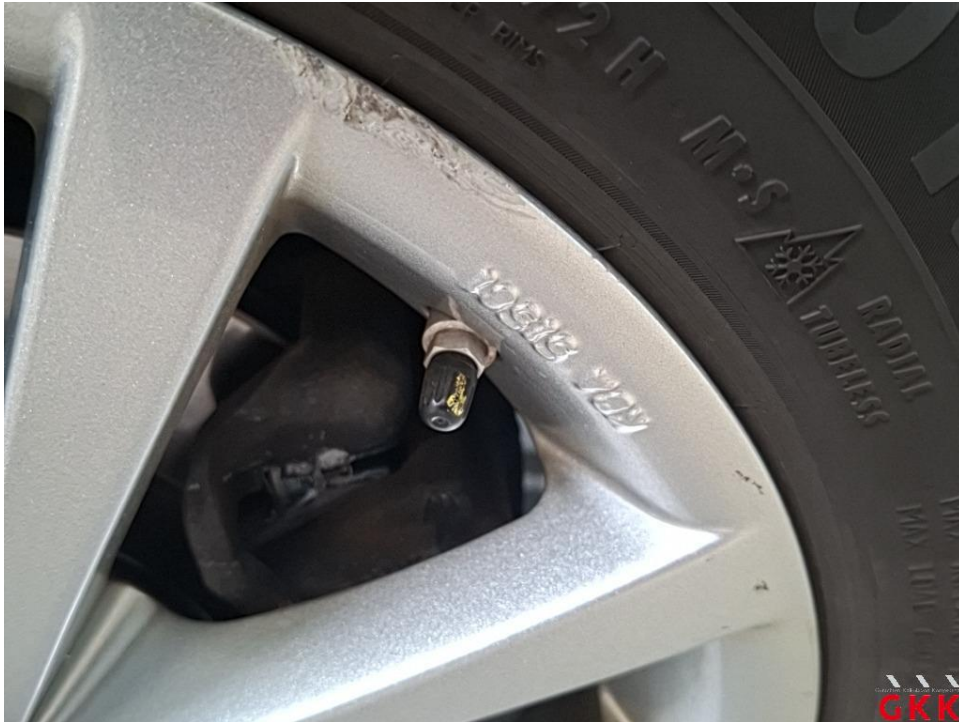
Bild 23. LM-Rad, vorne rechts, Materialabtrag, ersetzen
