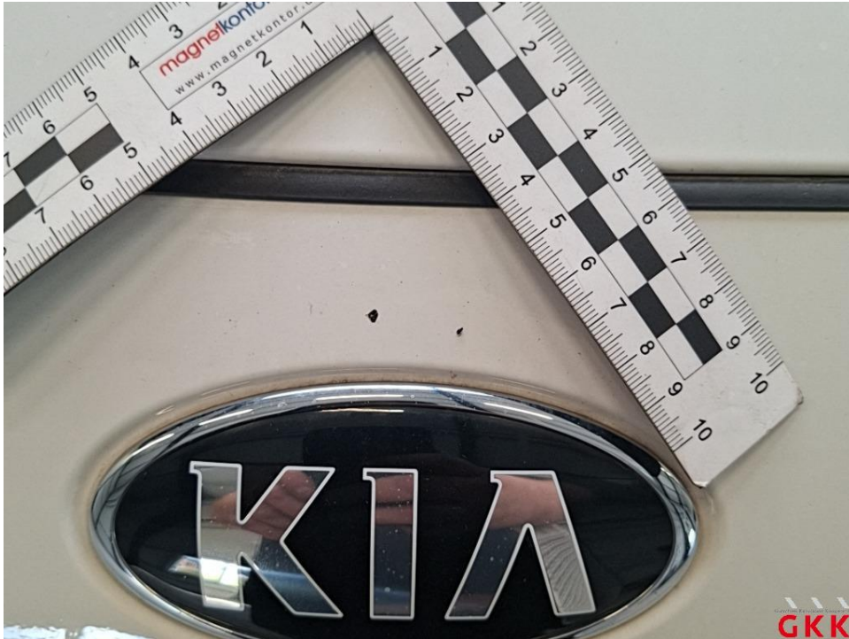
Bild 25. Stoßfänger vorne, Verkleidung oberhalb -lackiert-, verkratzt, lackieren
