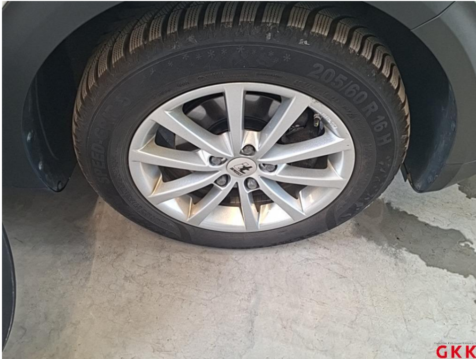
Bild 21. LM-Rad, vorne rechts, Materialabtrag, ersetzen
