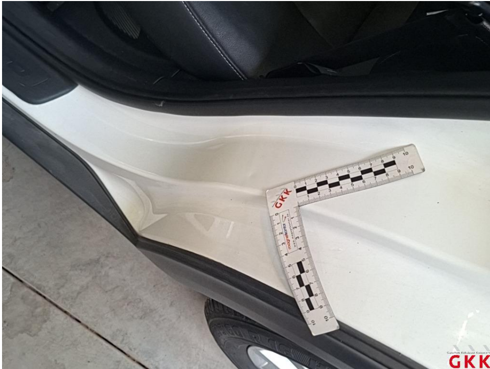
Bild 27. Tür hinten links, Einstieg, beschädigt, instand setzen - lackieren
