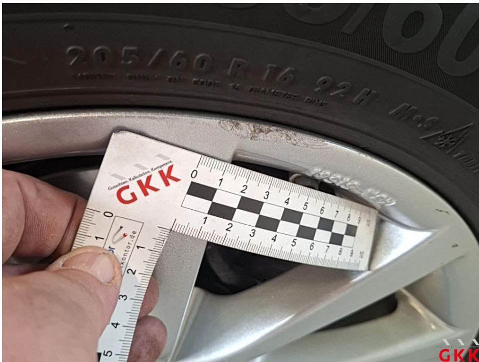
Bild 22. LM-Rad, vorne rechts, Materialabtrag, ersetzen
