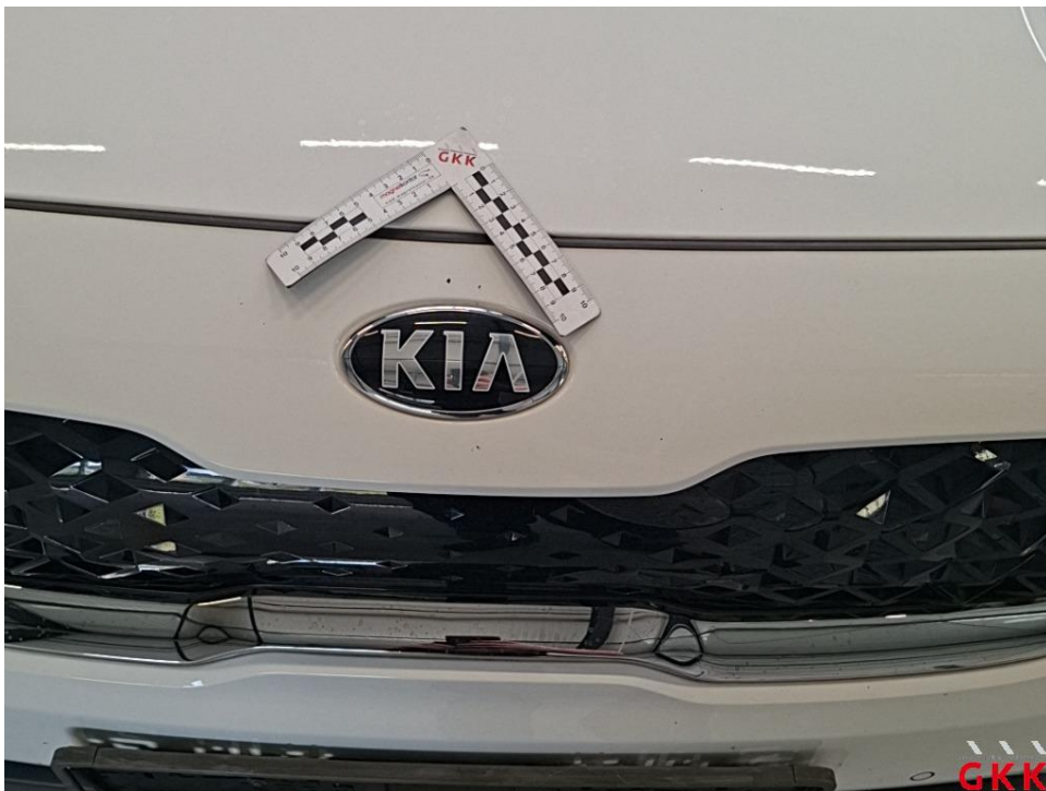
Bild 24. Stoßfänger vorne, Verkleidung oberhalb -lackiert-, verkratzt, lackieren
