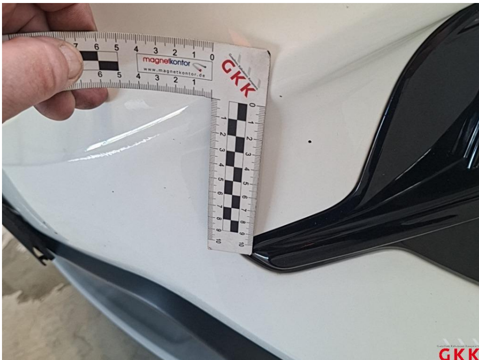
Bild 26. Stoßfänger vorne, Verkleidung oberhalb -lackiert-, verkratzt, lackieren
