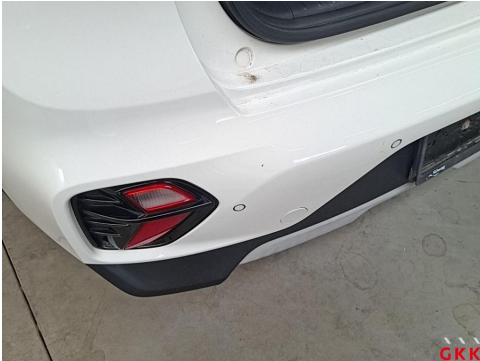
Bild 29. Stoßfänger hinten, Verkleidung oberhalb -lackiert-, verkratzt, lackieren
