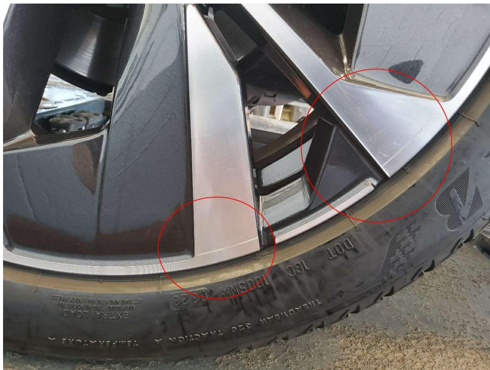
Bild 15 : Alufelge Glanzgedreht hinten rechts zerkratzt
