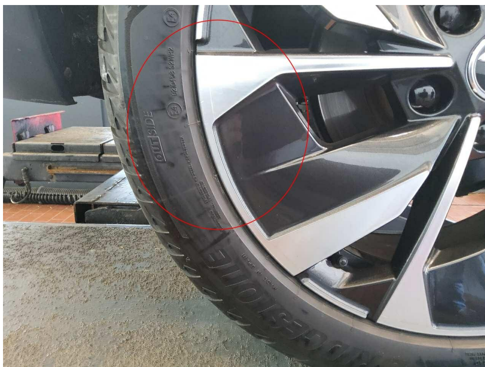
Bild 16 : Alufelge Glanzgedreht hinten rechts zerkratzt
