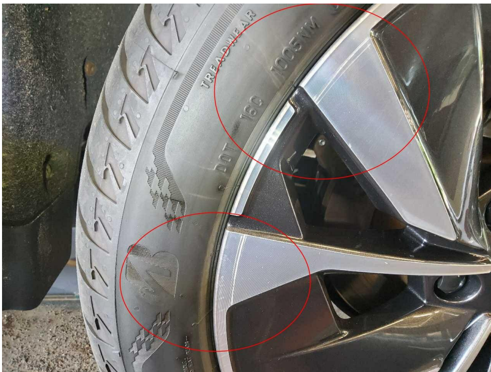
Bild 14 : Alufelge Glanzgedreht vorne rechts zerkratzt mit Materialabtrag
