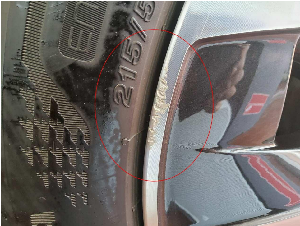
Bild 13 : Alufelge Glanzgedreht vorne rechts zerkratzt mit Materialabtrag
