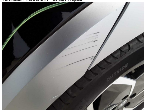
Beschädigung #5: Tür hinten links: Zierleiste unten - verkratzt / verschürft - Smart Repair
