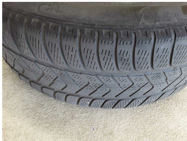
Beschädigung #1: 2.Radsatz: 2 Reifen - verschlissen - kein Abzug
