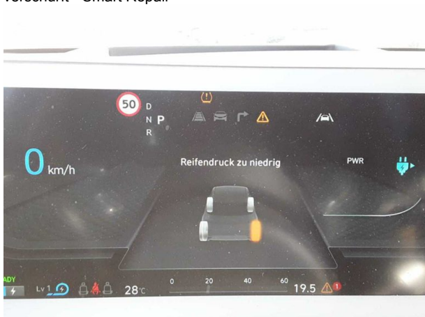
Beschädigung #6: Instrumententafel: Kontrollleuchte (RDKS leuchtet) - Befund festlegen - befunden ggf. instandsetzen
