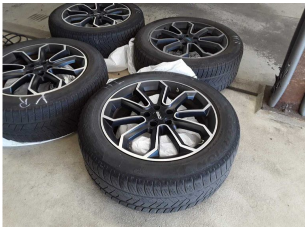
Beschädigung #1: 2.Radsatz: 2 Reifen - verschlissen - kein Abzug
