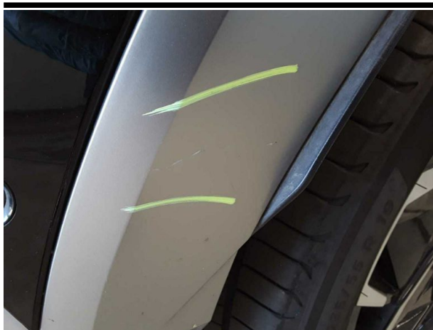
Beschädigung #4: Kotflügel rechts: Radhausverbreiterung - verkratzt / verschürft - Smart Repair
