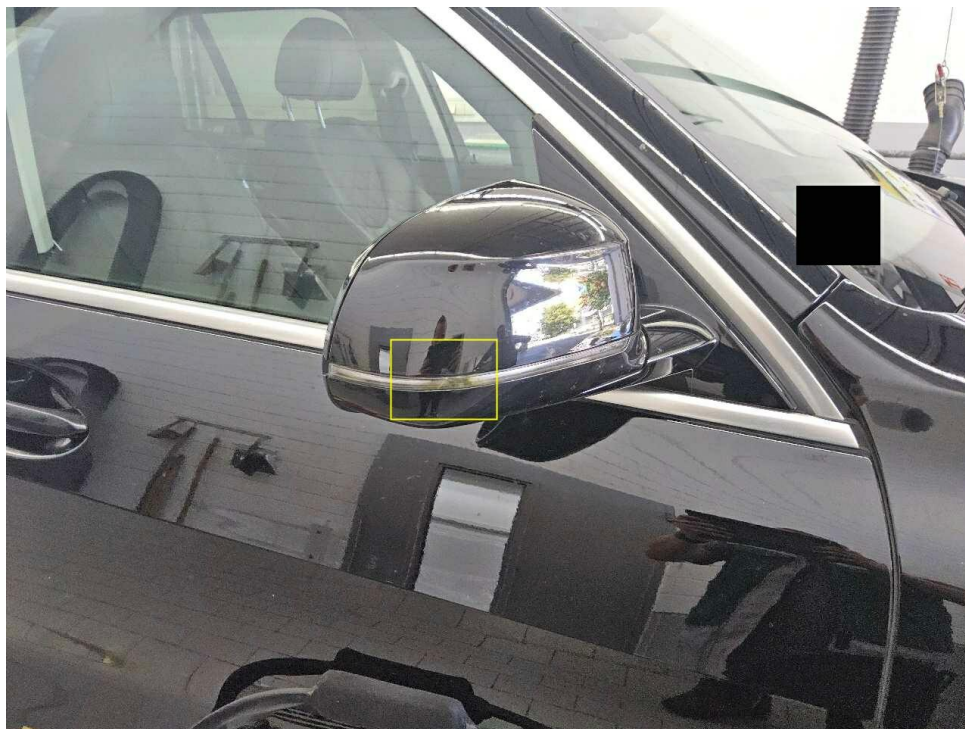
Bild 41 : Außenspiegelverkleidung rechts Blinkleuchte, gerissen
