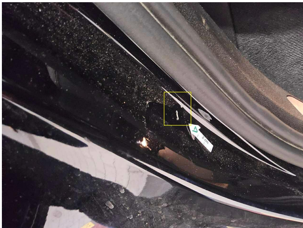
Bild 46 : Tür hinten rechts Einstieg, zerkratzt
