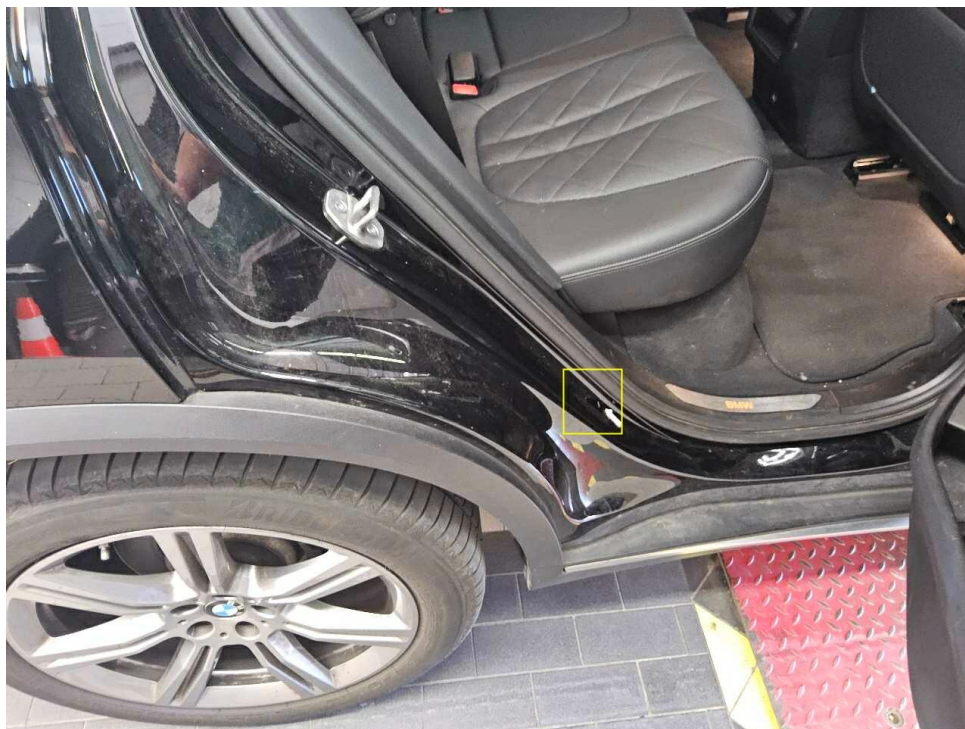
Bild 45 : Tür hinten rechts Einstieg, zerkratzt
