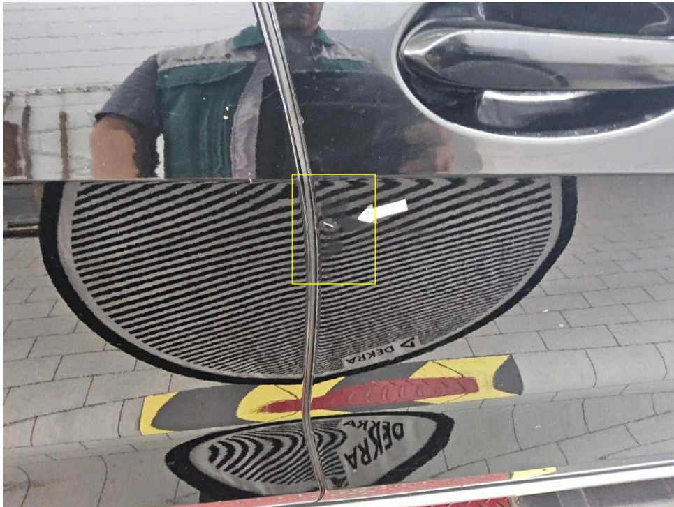
Bild 27 : Tür vorne rechts, eingedellt, instandsetzen und lackieren mit Lackaufbau
