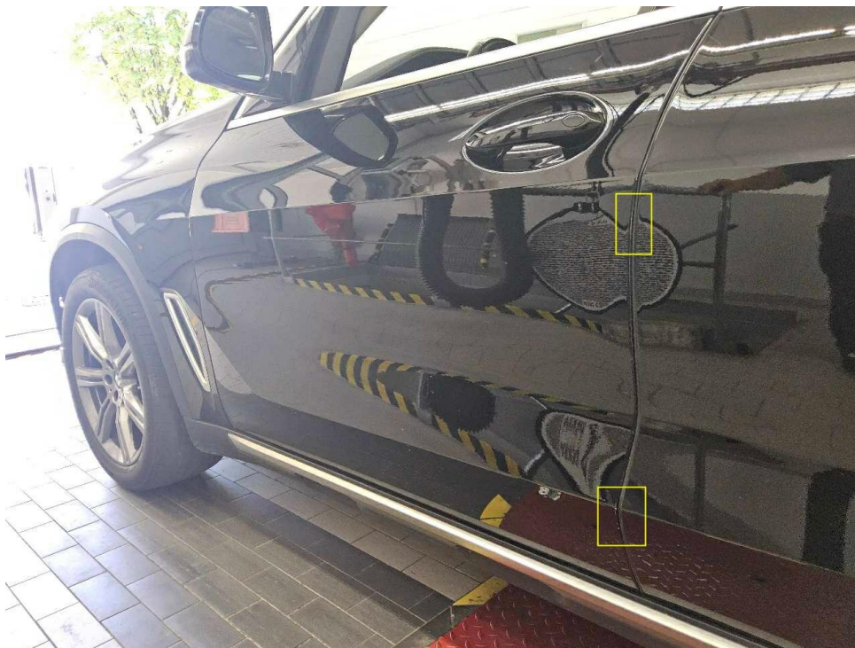
Bild 24 : Tür vorne links Kante, zerkratzt
