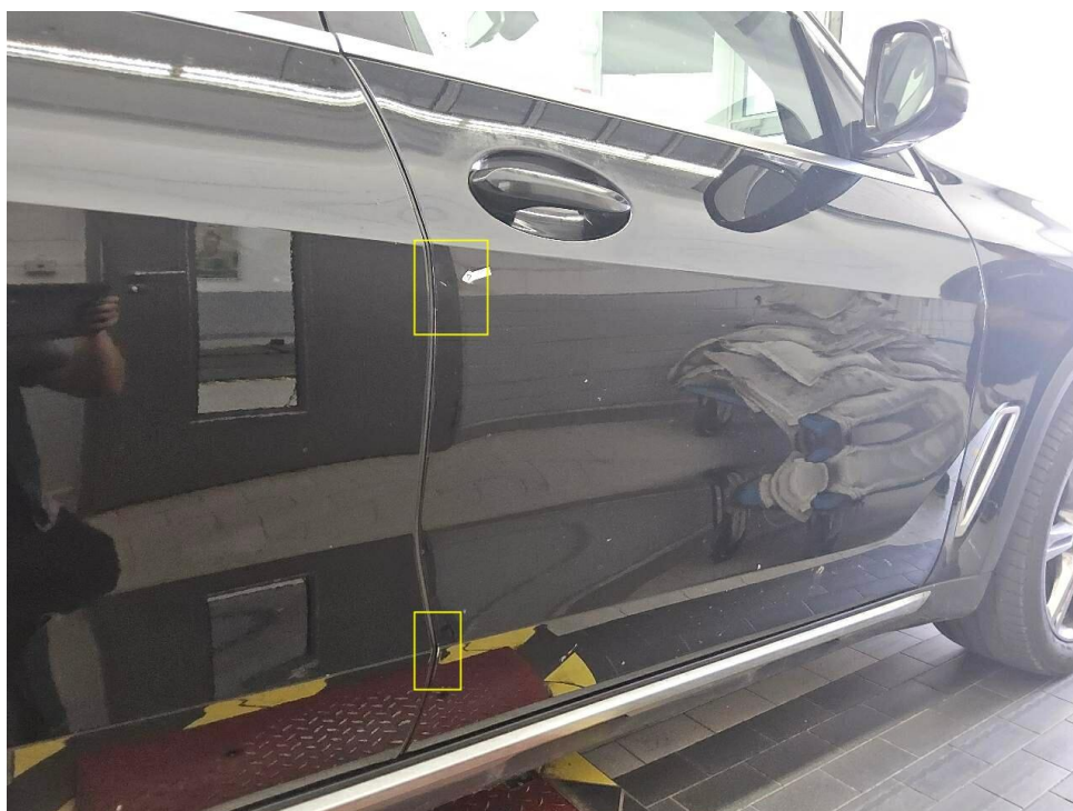
Bild 26 : Tür vorne rechts, eingedellt, instandsetzen und lackieren mit Lackaufbau
