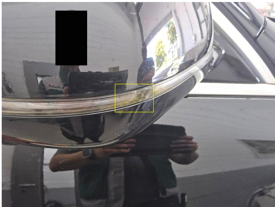
Bild 42 : Außenspiegelverkleidung rechts Blinkleuchte, gerissen
