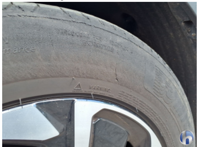
15. Reifen Vorne - Rechts Beschädigt - Erneuern
