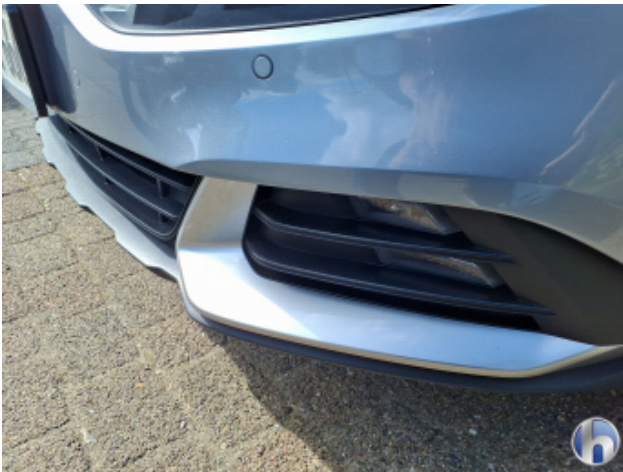
6. Stoßfänger Vorne Kratzer - Smart Repair
