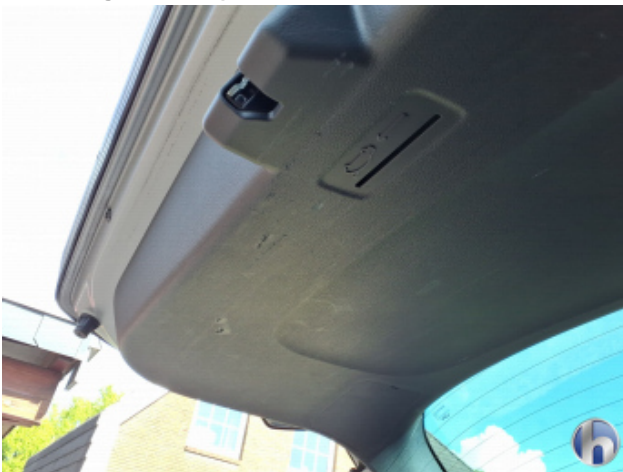
13. Verkleidung Kratzer - Erneuern
