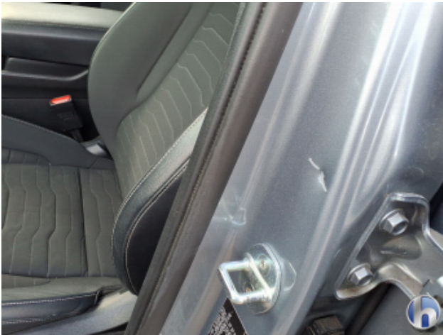
1. Schweller - Links Verdellt - Instandsetzen und Lackieren
