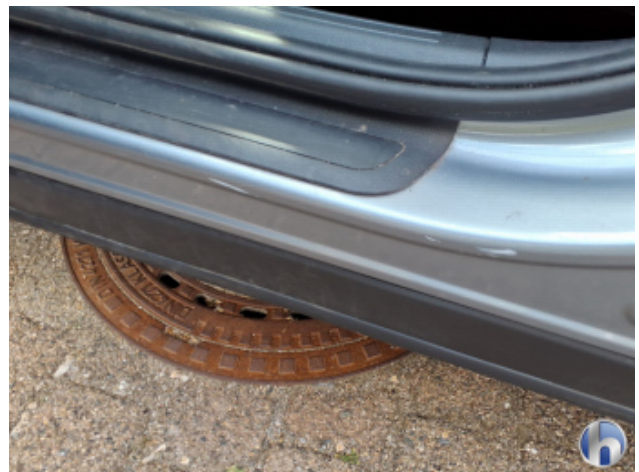
1. Schweller - Links Verdellt - Instandsetzen und Lackieren
