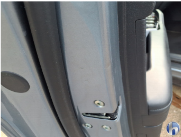
2. Tür Vorne - Links Verdellt - Sanft Instandsetzen
