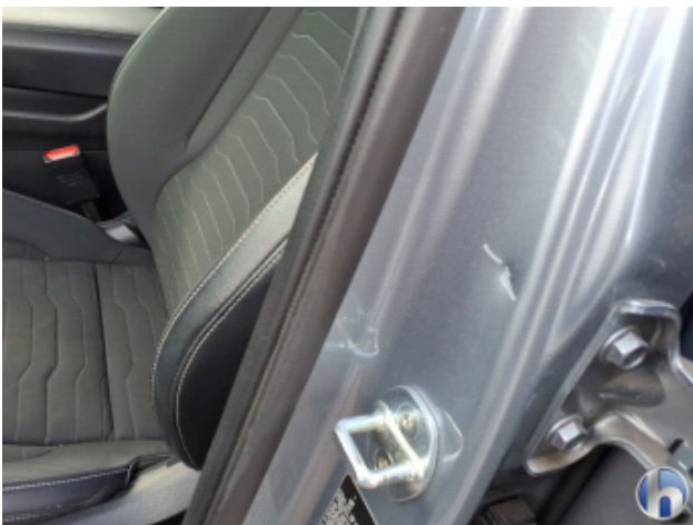
1. Schweller - Links Verdellt - Instandsetzen und Lackieren
