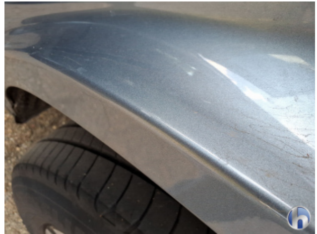
1. Schweller - Links Verdellt - Instandsetzen und Lackieren
