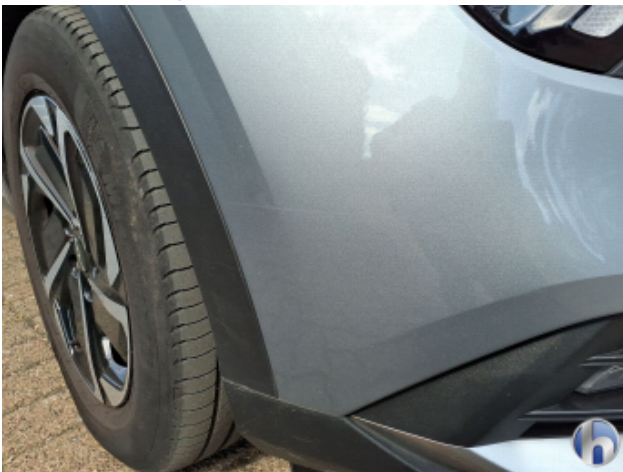
6. Stoßfänger Vorne Kratzer - Smart Repair
