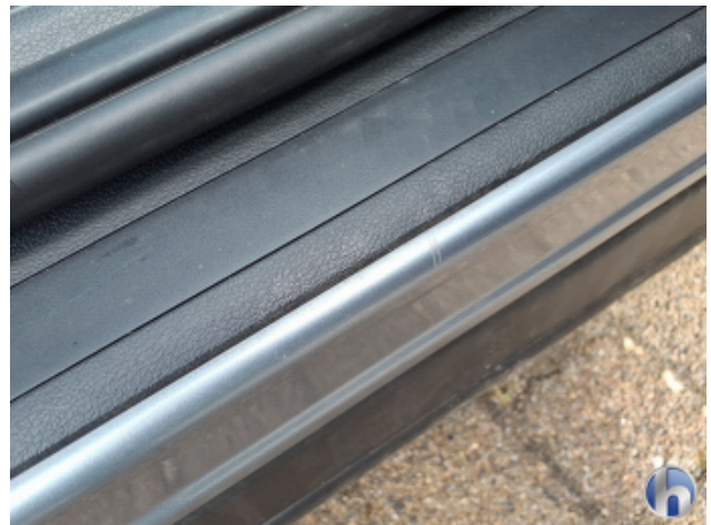
3. Schweller - Rechts Kratzer - Smart Repair
