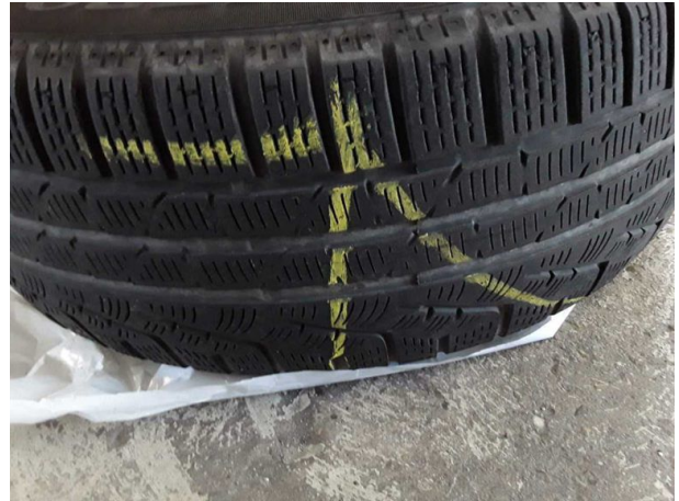
Beschädigung #1: 2.Radsatz: 2 Reifen - verschlissen - kein Abzug
