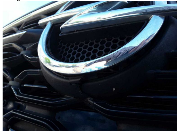
Beschädigung #2: Frontmaske: Emblem (Lose) - beschädigt - erneuern
