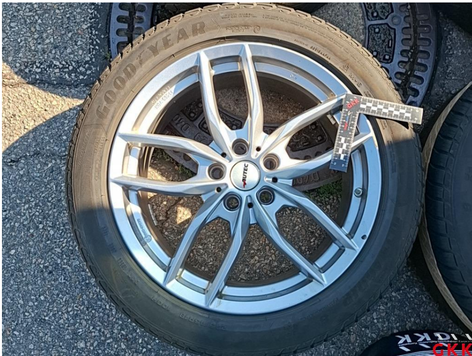
Bild 12. LM-Rad, 1 x beiliegend, verkratzt, lackieren
