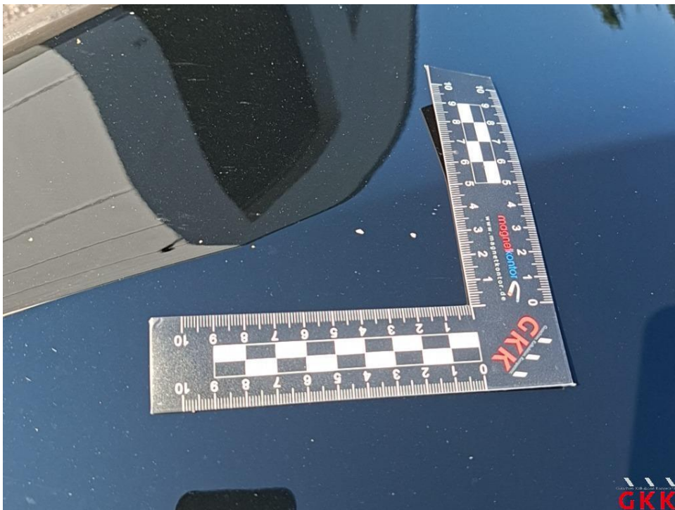
Bild 16. Motorhaube, Steinschlag, auslegen, schleifen, polieren
