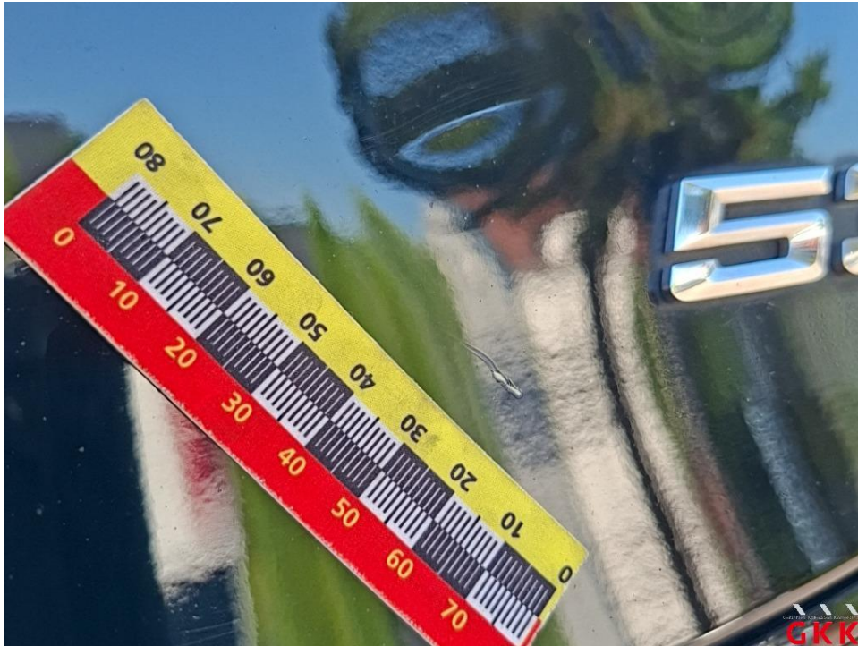
Bild 23. Heckklappe, beschädigt, instand setzen - lackieren
