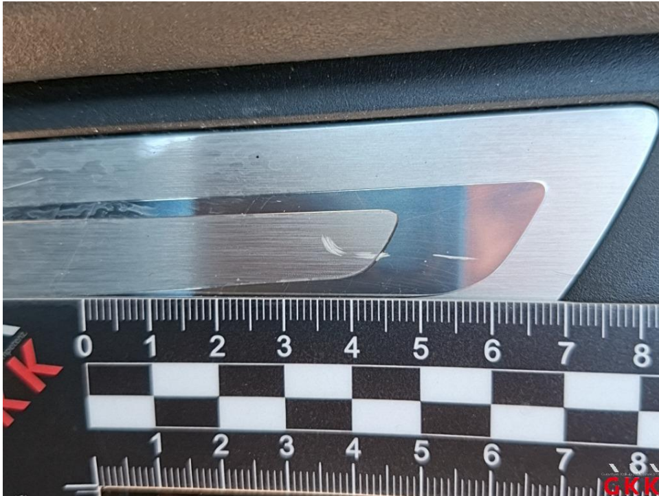
Bild 29. Tür hinten links, Einstiegsleiste, verkratzt, ersetzen
