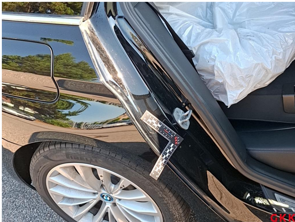
Bild 32. Tür hinten rechts, Einstieg, verkratzt, Spotlackieren
