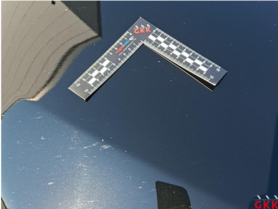
Bild 15. Motorhaube, Steinschlag, auslegen, schleifen, polieren
