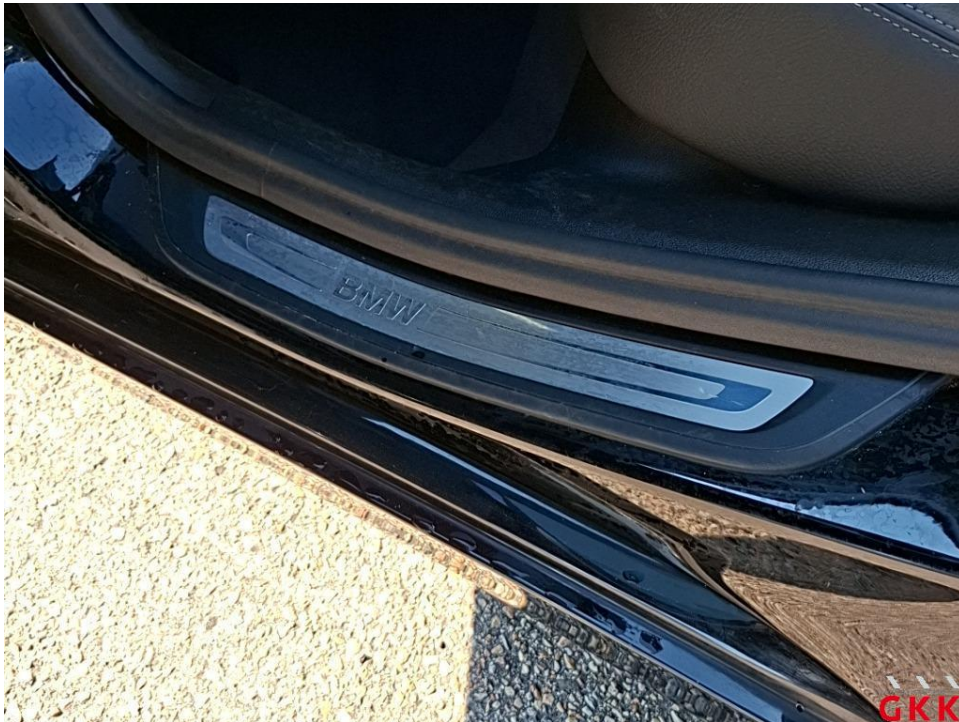
Bild 28. Tür hinten links, Einstiegsleiste, verkratzt, ersetzen
