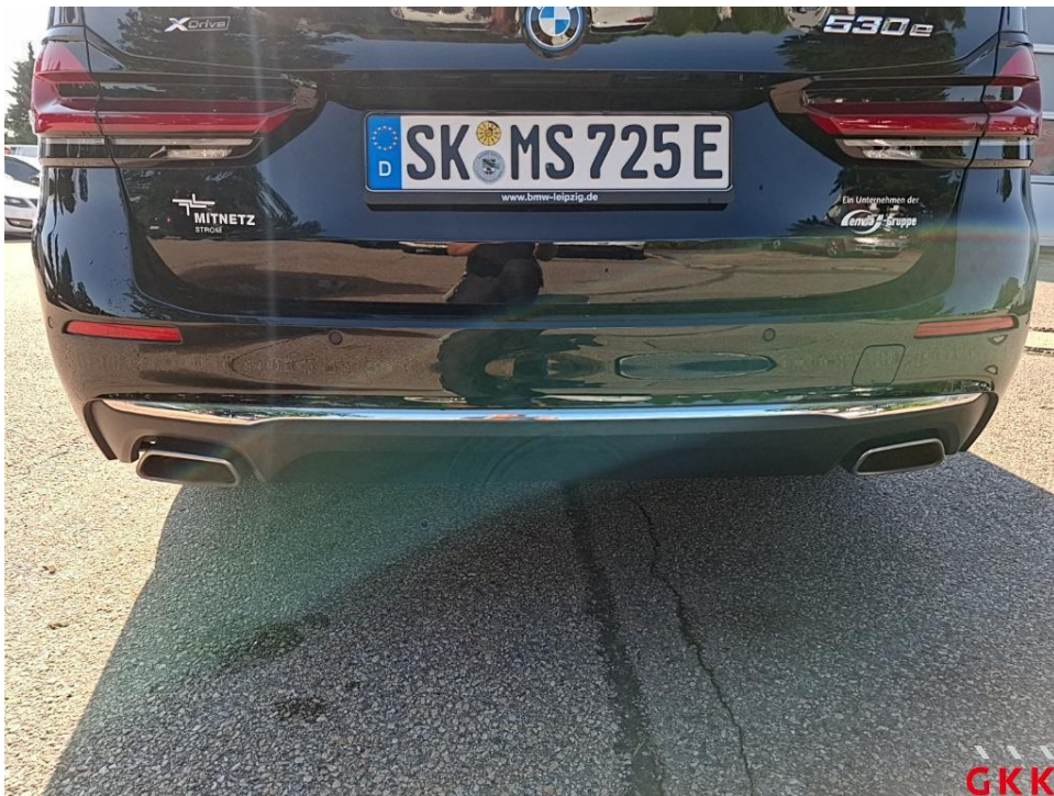
Bild 20. Stoßfänger hinten, Verkleidung -lackiert-, verkratzt, Spotlackieren
