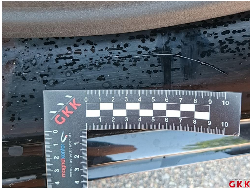
Bild 31. Tür vorne links, Einstieg, verkratzt, Spotlackieren
