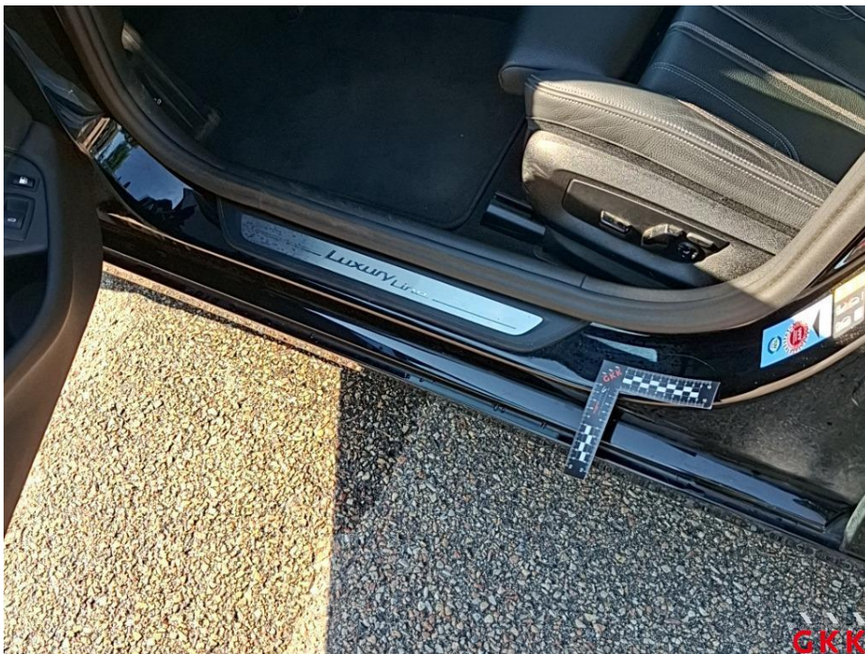
Bild 30. Tür vorne links, Einstieg, verkratzt, Spotlackieren
