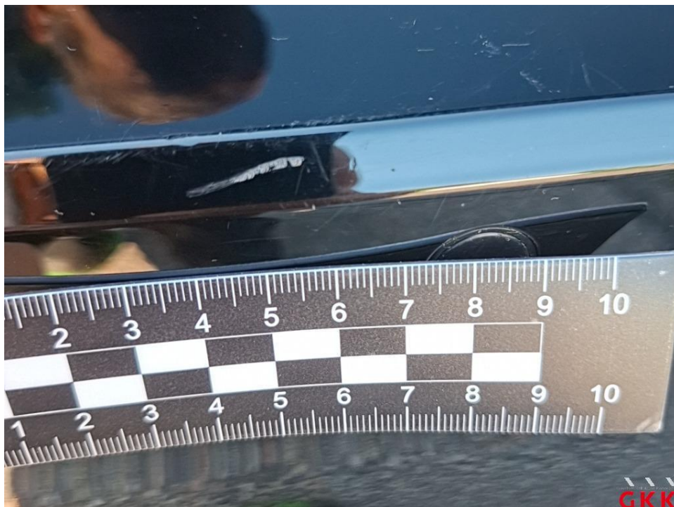
Bild 21. Stoßfänger hinten, Verkleidung -lackiert-, verkratzt, Spotlackieren
