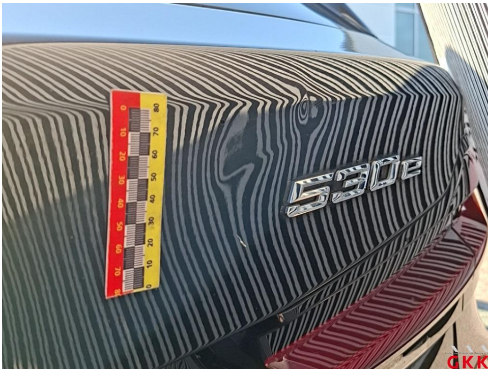
Bild 24. Heckklappe, beschädigt, instand setzen - lackieren
