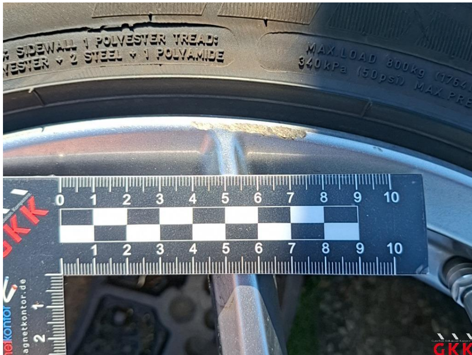
Bild 13. LM-Rad, 1 x beiliegend, verkratzt, lackieren
