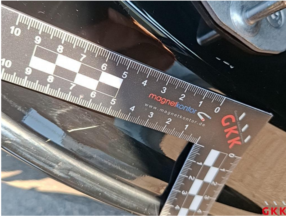
Bild 33. Tür hinten rechts, Einstieg, verkratzt, Spotlackieren
