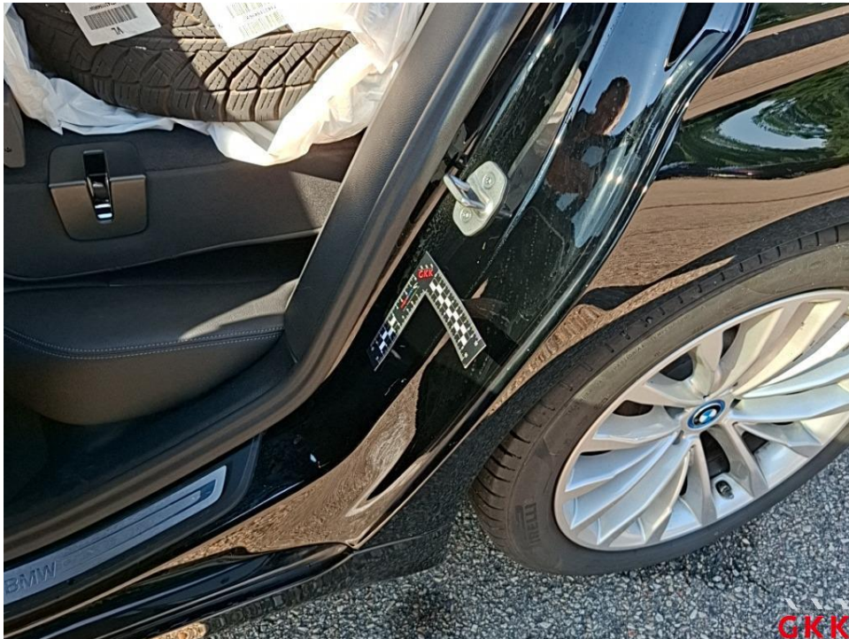
Bild 26. Tür hinten links, Einstieg, verkratzt, Spotlackieren
