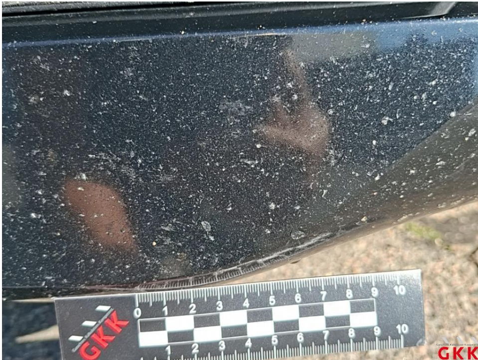
Bild 18. Stoßfänger vorne, Verkleidung -lackiert-, Steinschlag und Kratzer, lackieren
