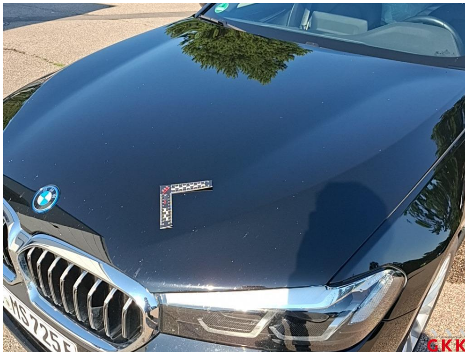
Bild 14. Motorhaube, Steinschlag, auslegen, schleifen, polieren
