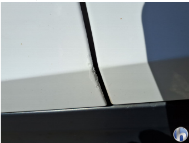
2. Tür Vorne - Links Unsachgemäß Instandgesetzt - Lackieren
