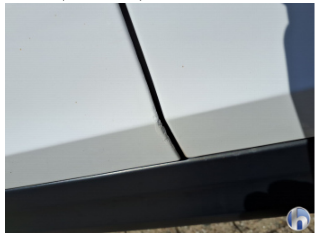
2. Tür Vorne - Links Unsachgemäß Instandgesetzt - Lackieren
