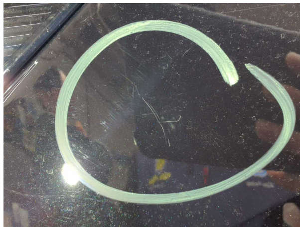
Beschädigung #1: Kotflügel links: Kotflügel links - Kratzer - auslegen / polieren
