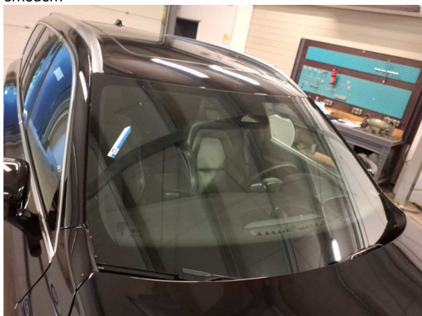
Beschädigung #4: Verglasung: Frontscheibe mit Spurhalteassistent (it Rissbildung) - Steinschlag - erneuern
