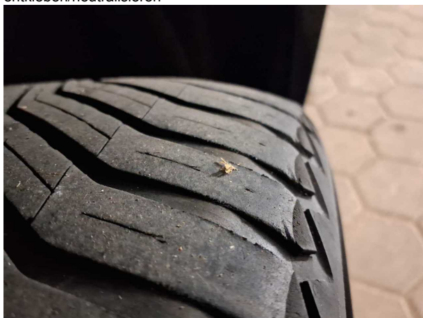
Beschädigung #3: Rad/Reifen: Reifensatz komplett - verschlissen - erneuern
