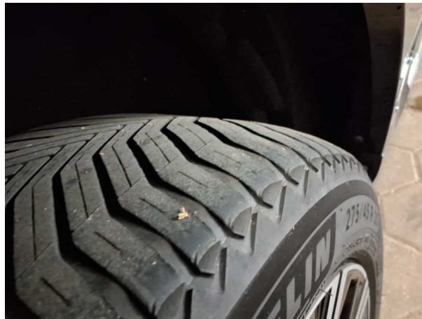
Beschädigung #3: Rad/Reifen: Reifensatz komplett - verschlissen - erneuern
