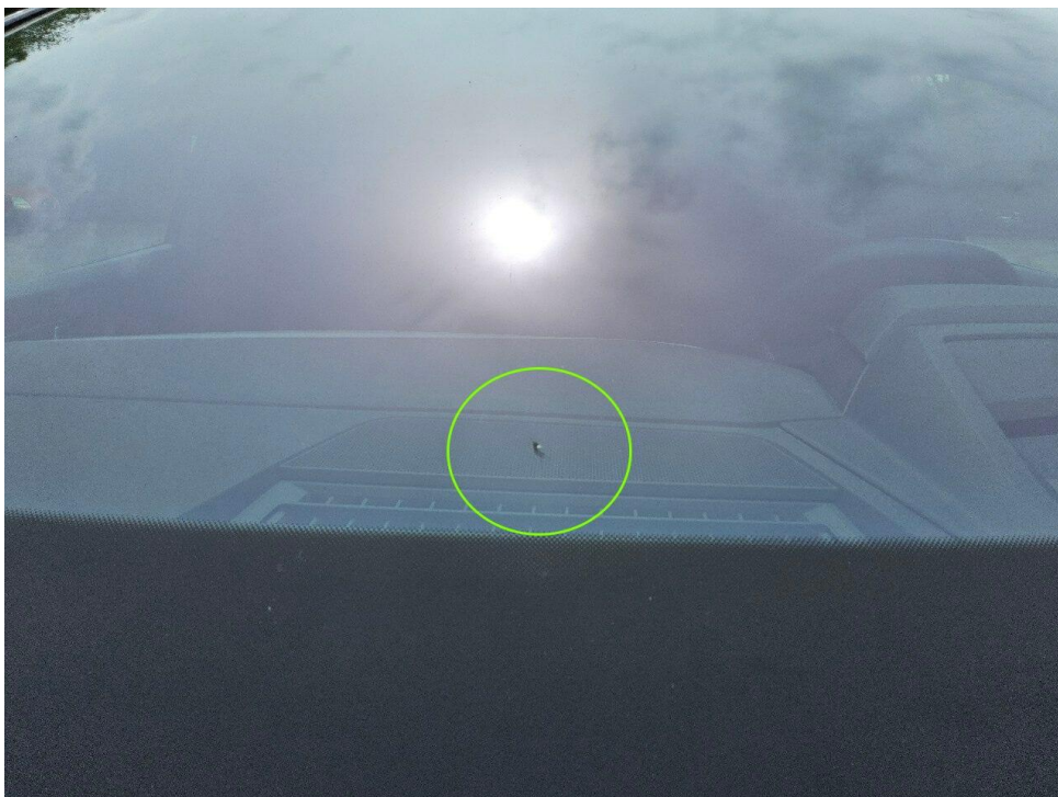
Bild 10 : Windschutzscheibe Steinschlag mit Rissbildung
