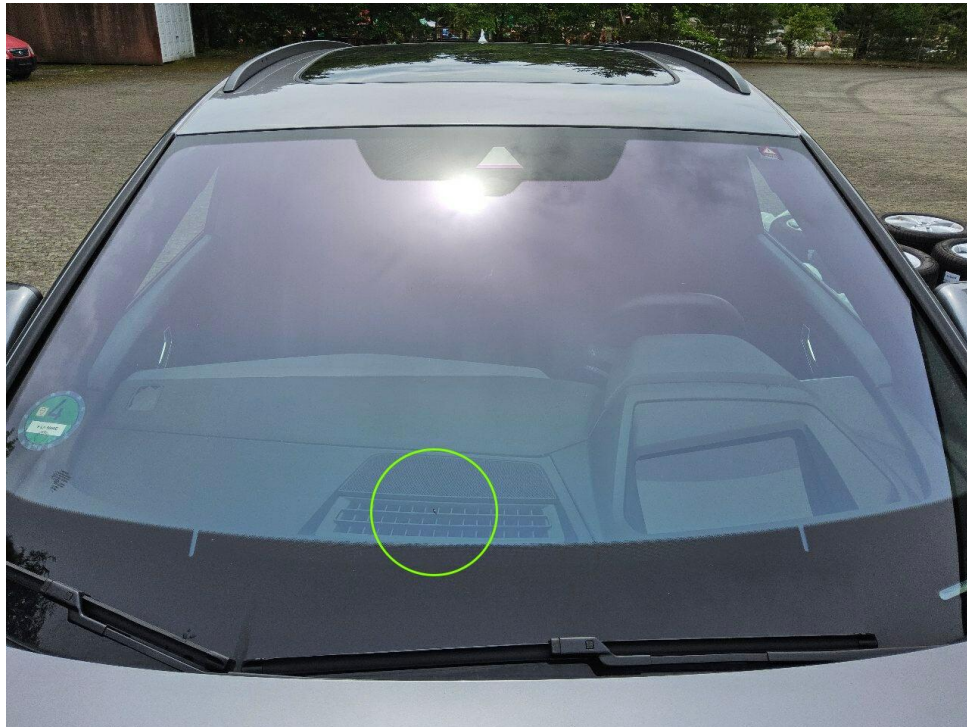
Bild 11 : Windschutzscheibe Steinschlag mit Rissbildung
