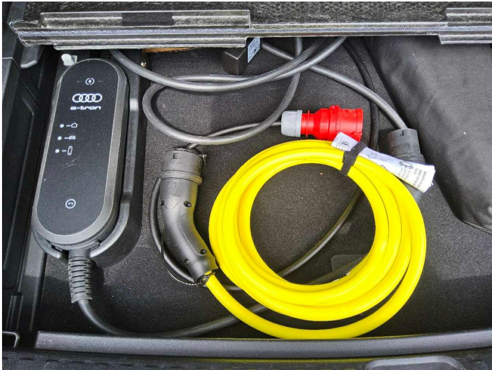
Bild 7 : Ladekabel beim E-Fahrzeug
