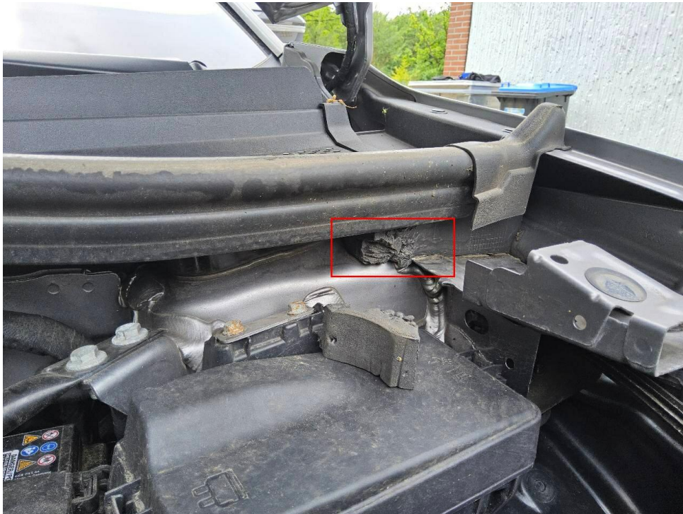
Bild 9 : Motorraum Dämmmaterial Tierbisse
