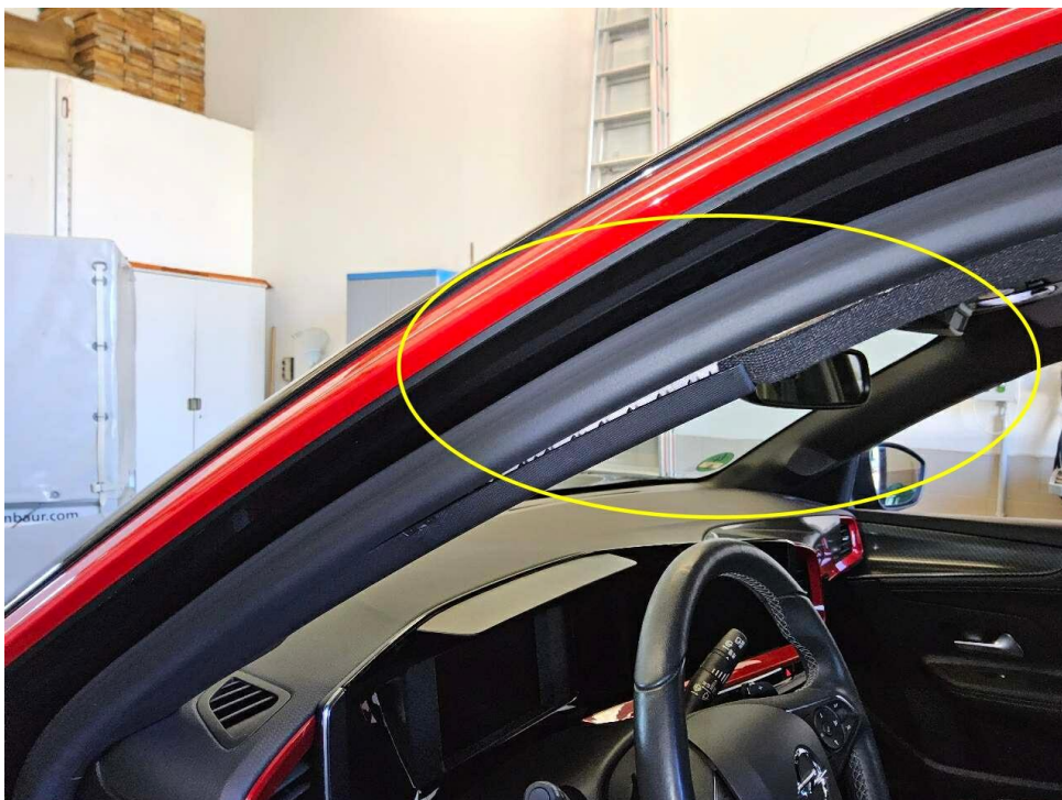
Bild 14 : Verkleidung A-Säule links, lose, befestigen
