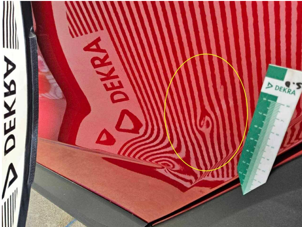
Bild 25 : Tür hinten links, eingedellt, drücken
