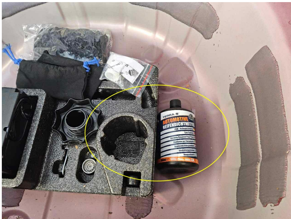
Bild 15 : Original Füllflasche fehlt
