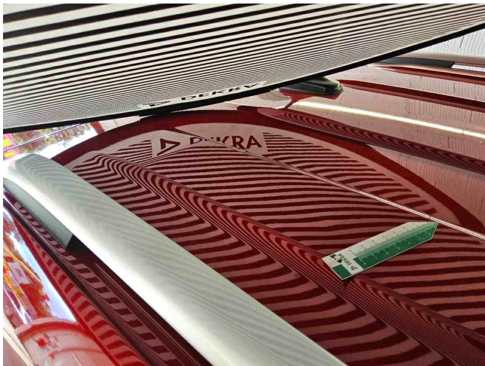
Bild 27 : Dach, eingedellt, Gebrauchsspur
