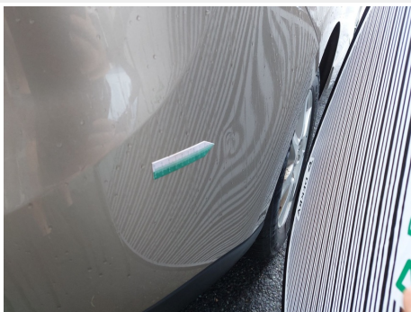
Stoßfänger / Hinten / Delle
