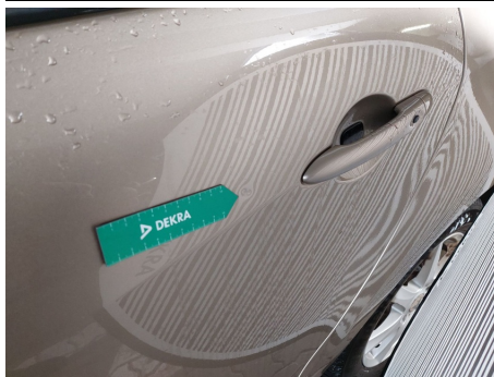
Tür / Hinten Links / Delle
