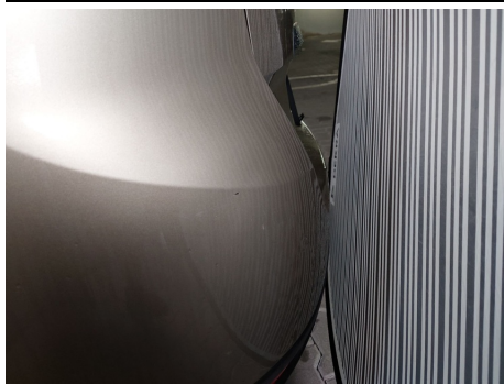
Stoßfänger / Hinten / Delle
