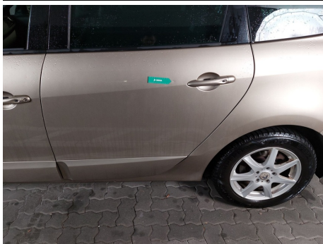
Tür / Hinten Links / Delle
