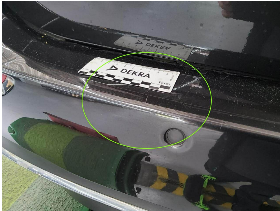
Bild 21 : Stoßfänger hinten Lackierung, zerkratzt, polieren
