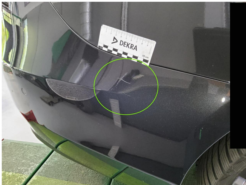
Bild 19 : Stoßfänger hinten Lackierung, verschrammt, smart repair
