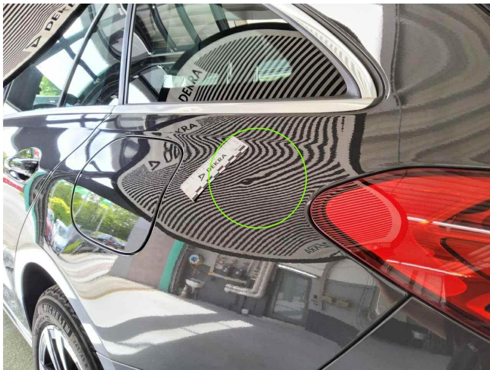
Bild 22 : Seitenteil hinten links, mehrfach eingedellt, drücken
