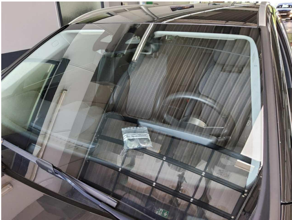
Bild 30 : Frontscheibe, Steinschlag, Gebrauchsspur
