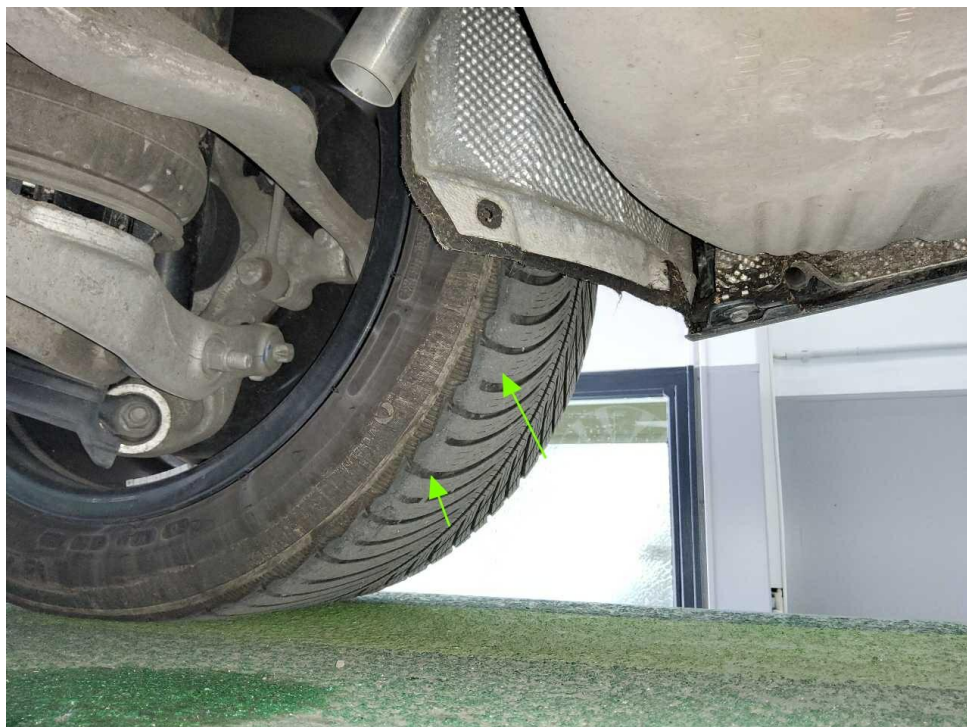
Bild 28 : Achsvermessung durchführen (Reifen HA RE innen verschlissen) und Achse 2, Reifen Rechts 1
