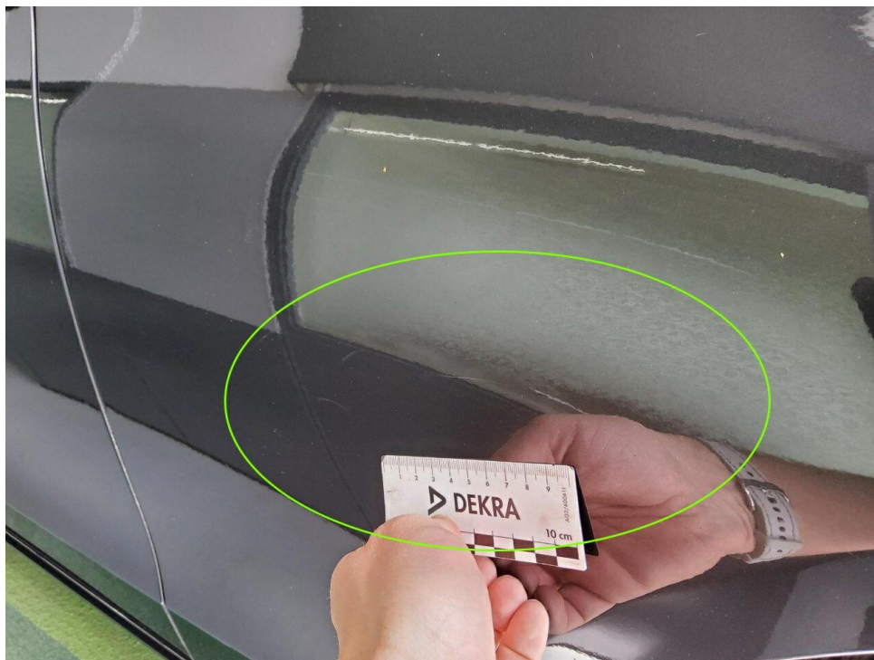
Bild 17 : Kotflügel vorne rechts Lackierung, zerkratzt, polieren
