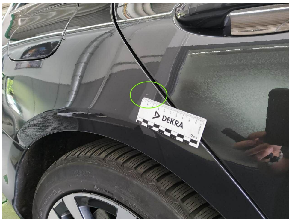
Bild 18 : Seitenteil hinten rechts Lackierung, zerkratzt, polieren
