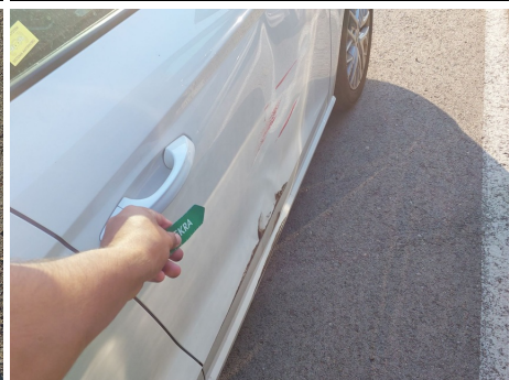
Puerta / Delantero Derecho / Abolladura
