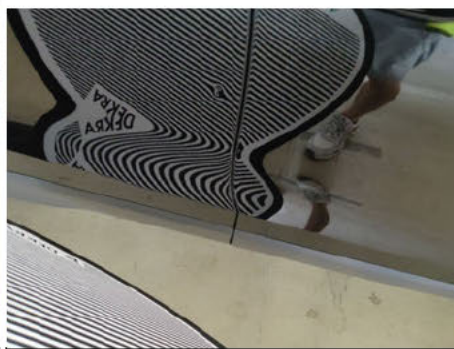
Tür / Hinten Rechts / Delle
