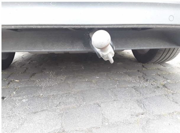
Beschädigung #2: Heckbereich: Anhängerkupplung (schwenkt nicht vollständig aus) - Fehlstellung - Diagnose durchführen
