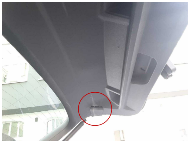
Beschädigung #3: Verkleidungen/Abdeckungen: Heckdeckel, Innenverkleidung (Abdeckung für Heckleuchte) - lose -
