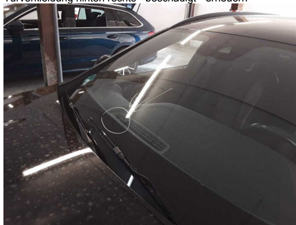
Beschädigung #8: Verglasung: Frontscheibe (Rissbildung) - Steinschlag - erneuern
