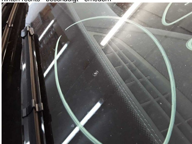
Beschädigung #8: Verglasung: Frontscheibe (Rissbildung) - Steinschlag - erneuern
