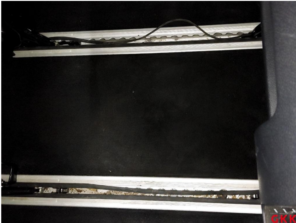
Bild 28 Sitzschienendichtung lose, ersetzen
