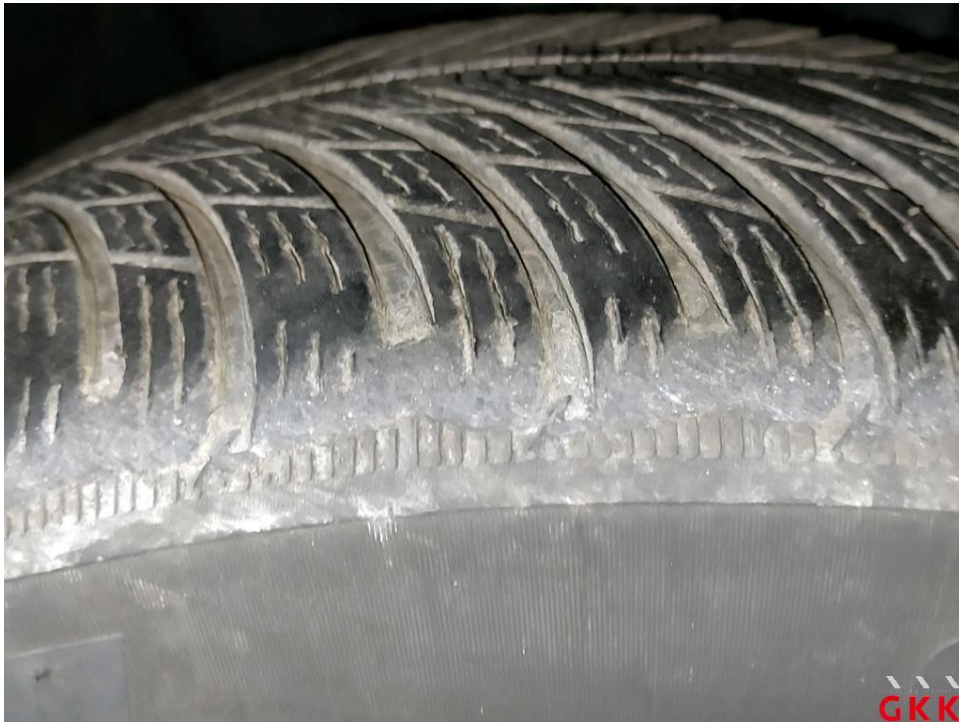
Bild 24 Reifen, vorn links und rechts, einseitig abgefahren, ersetzen
