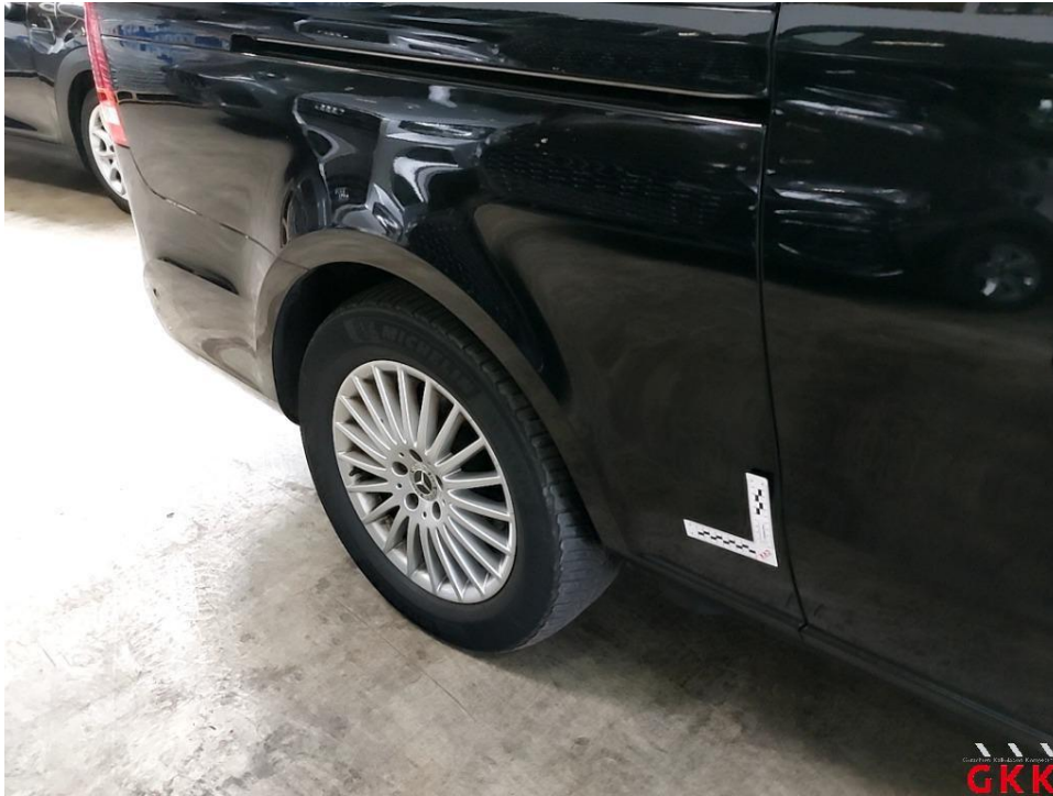
Bild 29 Seitenwand rechts, verkratzt, Smartrepair
