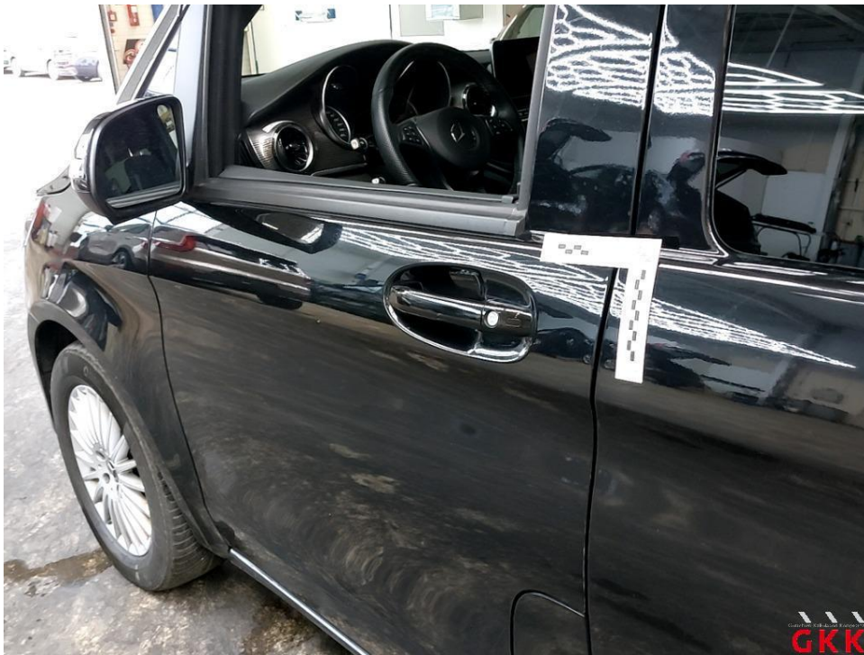
Bild 17 Tür vorne links eingedellt und verkratzt, Smartrepair
