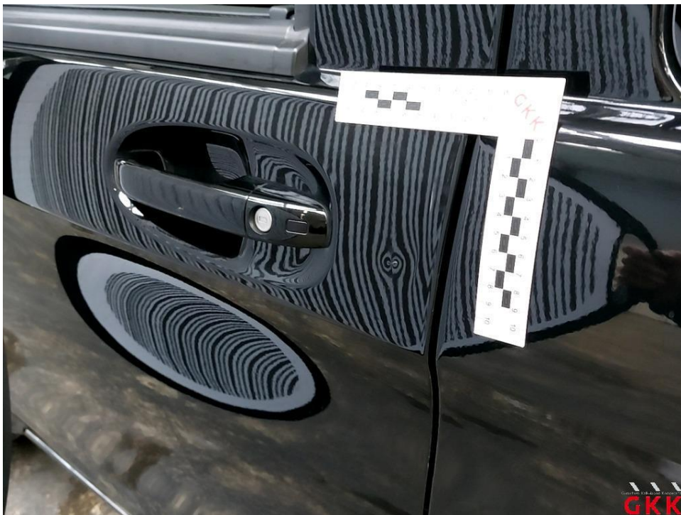
Bild 18 Tür vorne links eingedellt und verkratzt, Smartrepair
