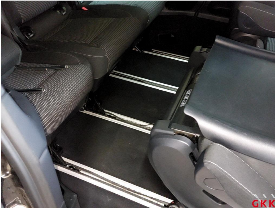
Bild 27 Sitzschienendichtung lose, ersetzen
