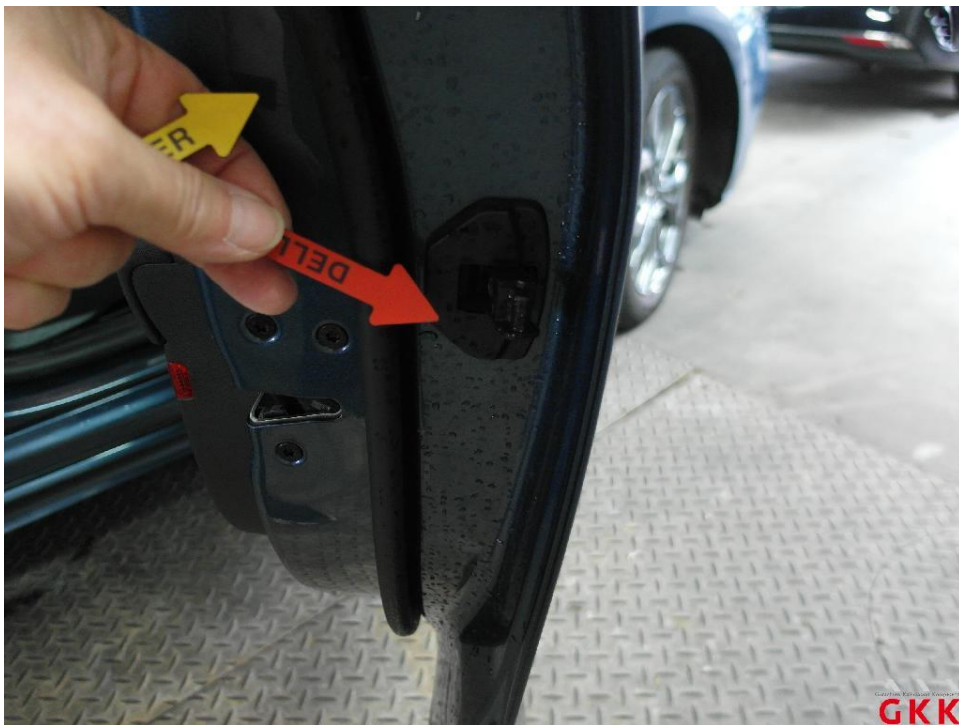
Bild 22. Tür vorne rechts - Kantenschutz, beschädigt, ersetzen
