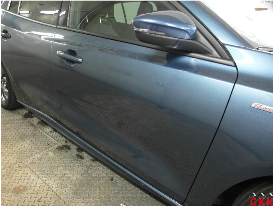
Bild 21. Tür vorne rechts - Kantenschutz, beschädigt, ersetzen
