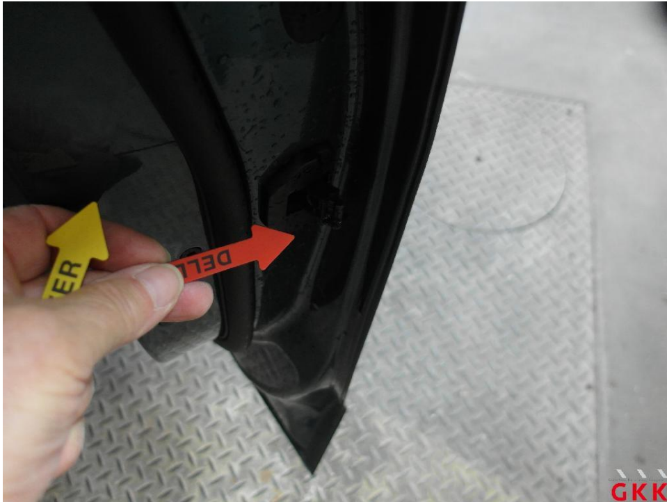
Bild 23. Tür vorne rechts - Kantenschutz, beschädigt, ersetzen
