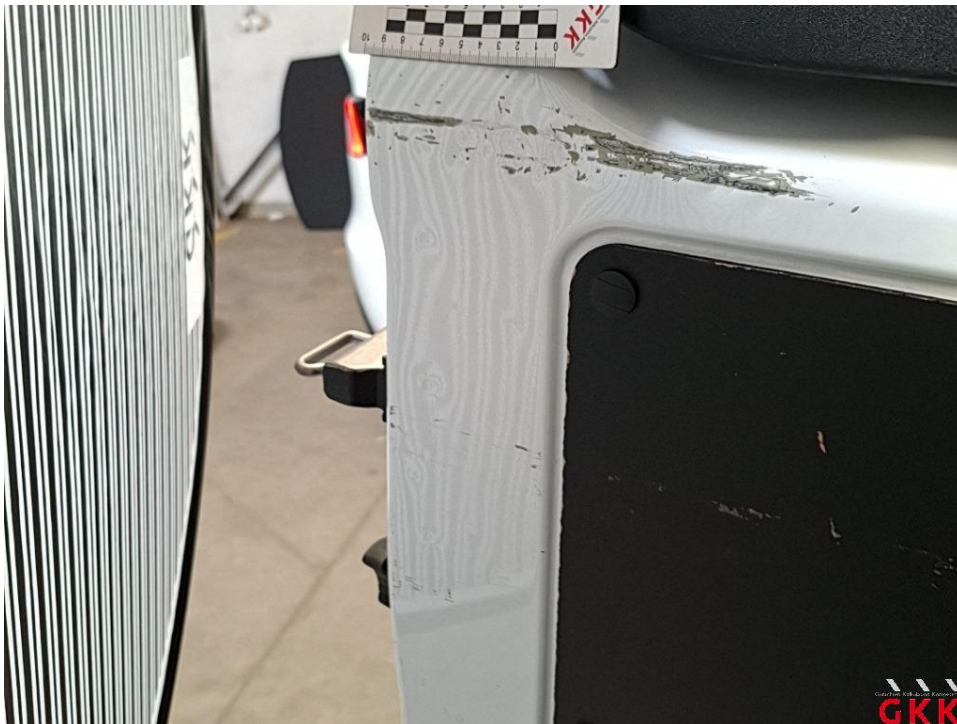
Bild 34 Hecktür links, innen, beschädigt, instand setzen - lackieren
