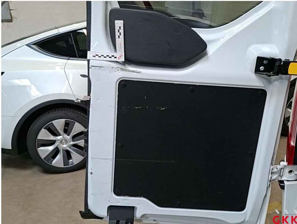
Bild 33 Hecktür links, innen, beschädigt, instand setzen - lackieren
