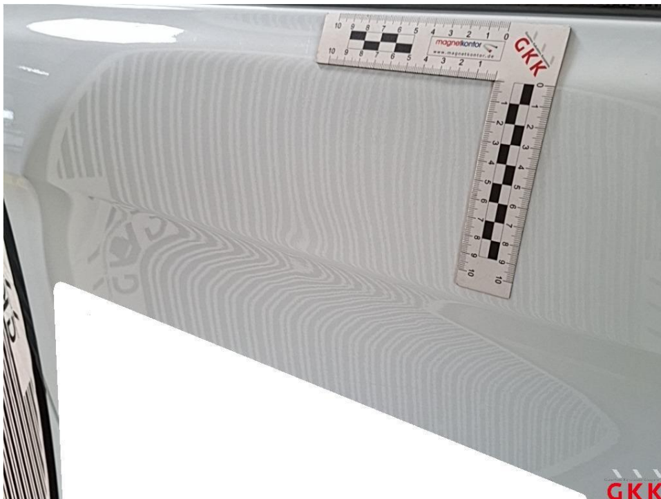
Bild 28 Schiebetür rechts, beschädigt, instand setzen - lackieren
