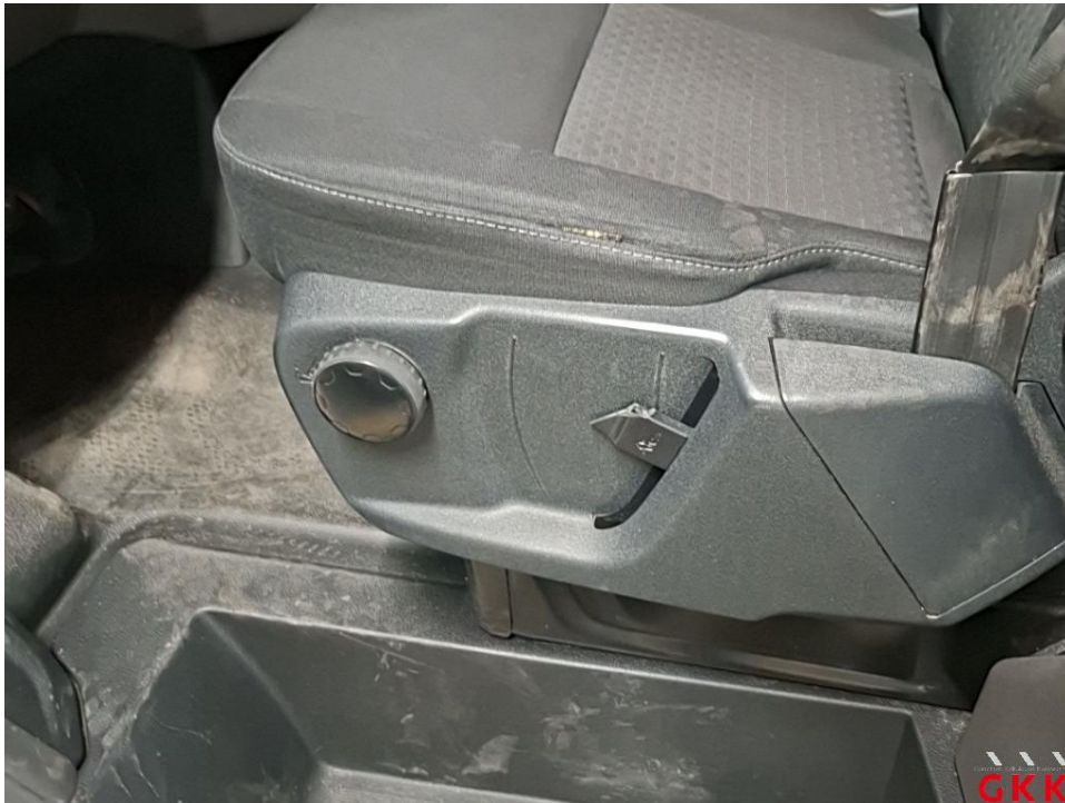
Bild 23 Sitz vorne links, Lehnverstellung, beschädigt, ersetzen
