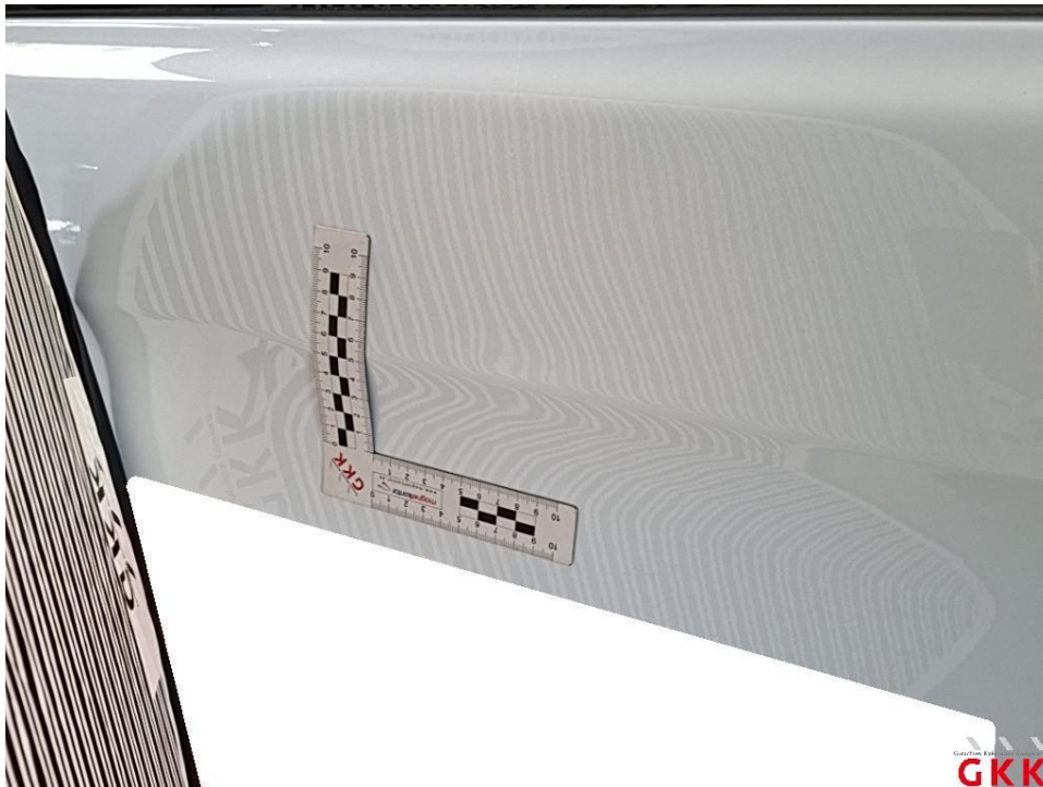
Bild 29 Schiebetür rechts, beschädigt, instand setzen - lackieren
