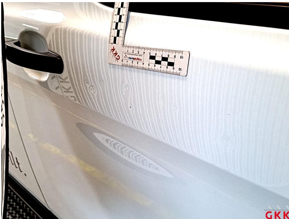
Bild 26 Tür vorne rechts, beschädigt, instand setzen - lackieren
