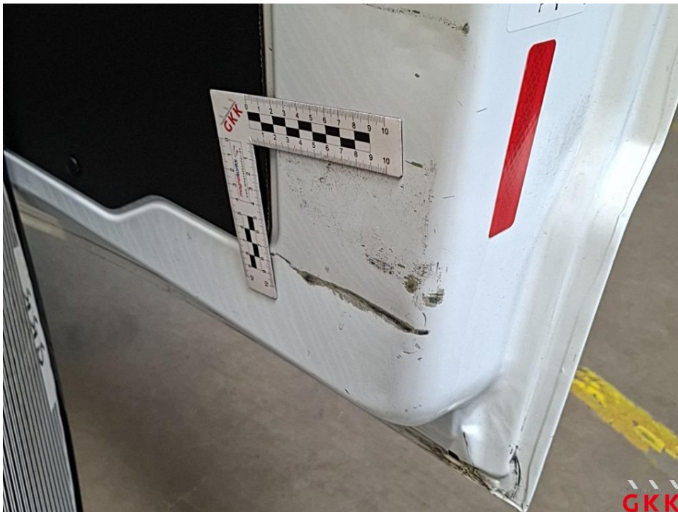
Bild 32 Hecktür rechts, innen, beschädigt, instand setzen - lackieren
