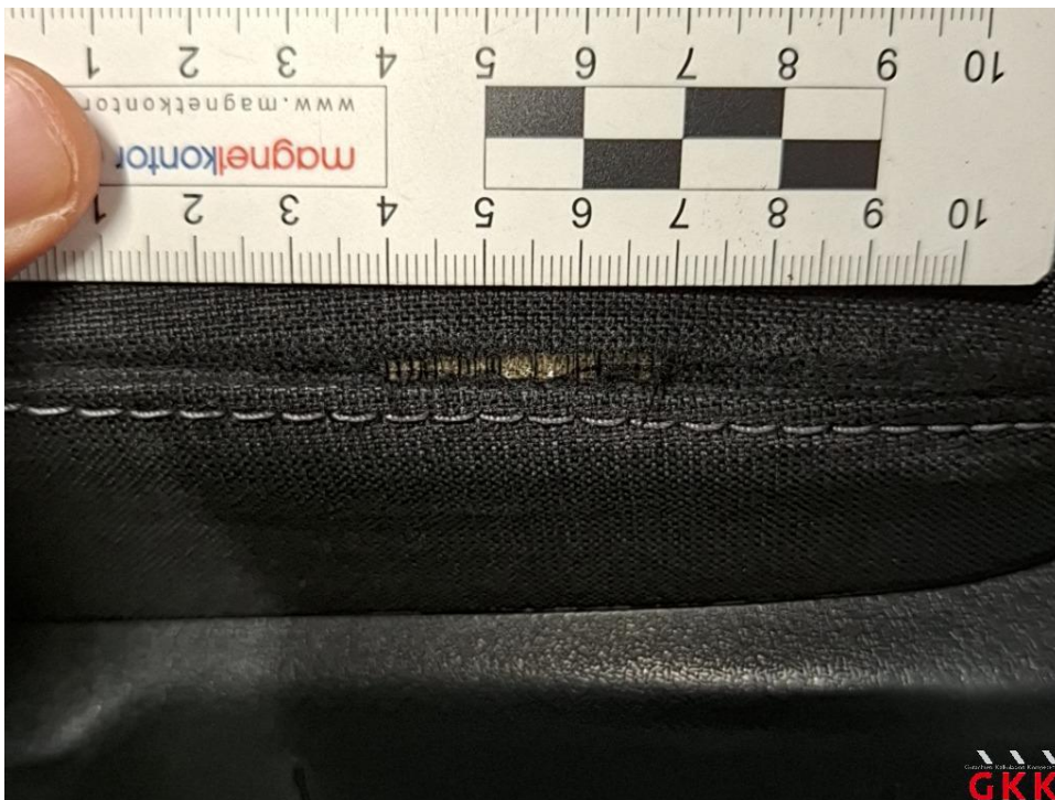
Bild 22 Sitz vorne links, Bezug Sitzkissen -Stoff-, gerissen, Smartrepair
