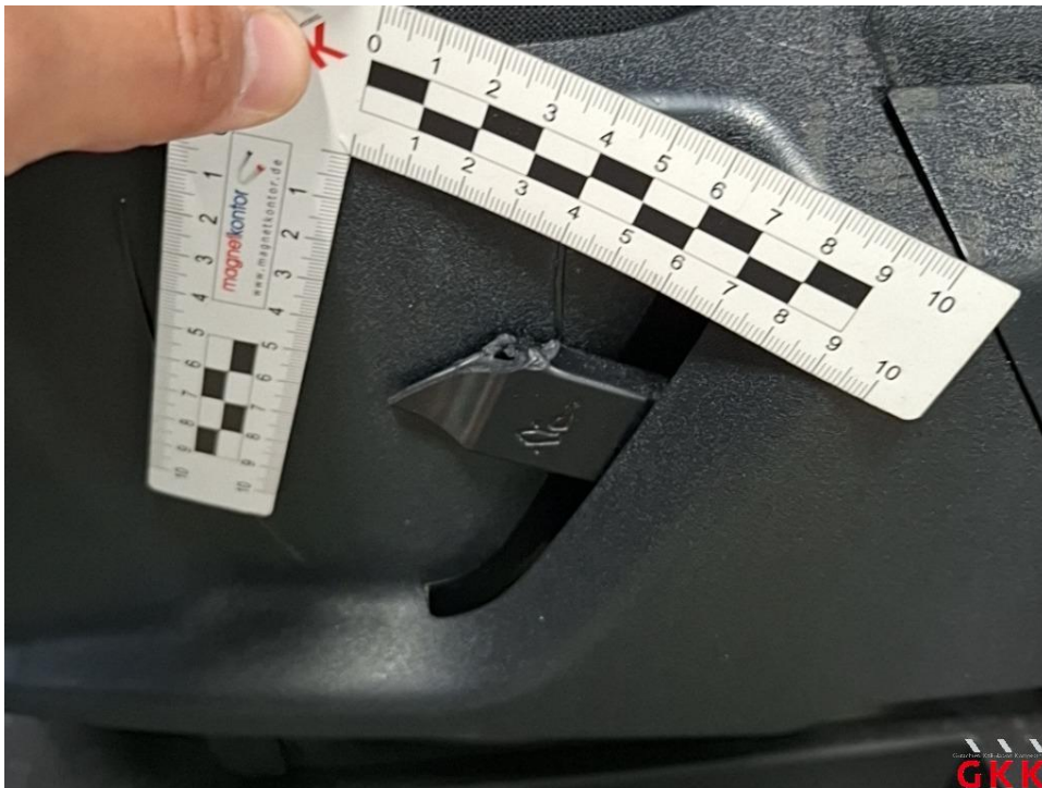
Bild 24 Sitz vorne links, Lehnverstellung, beschädigt, ersetzen
