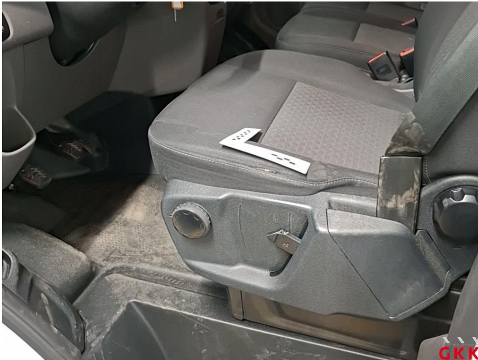
Bild 21 Sitz vorne links, Bezug Sitzkissen -Stoff-, gerissen, Smartrepair
