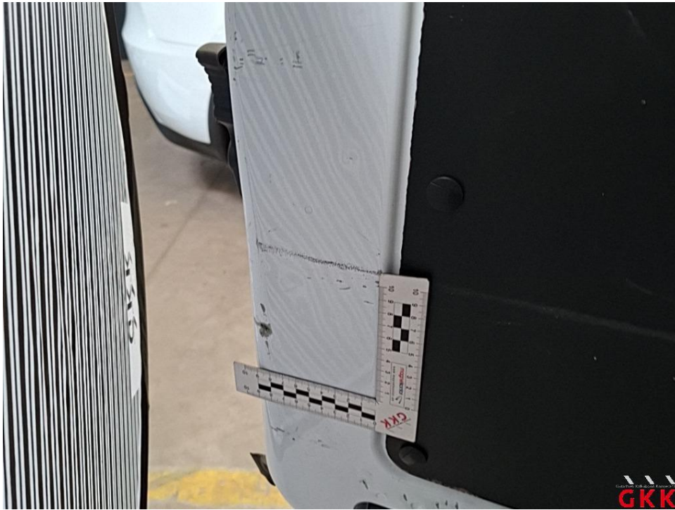
Bild 35 Hecktür links, innen, beschädigt, instand setzen - lackieren
