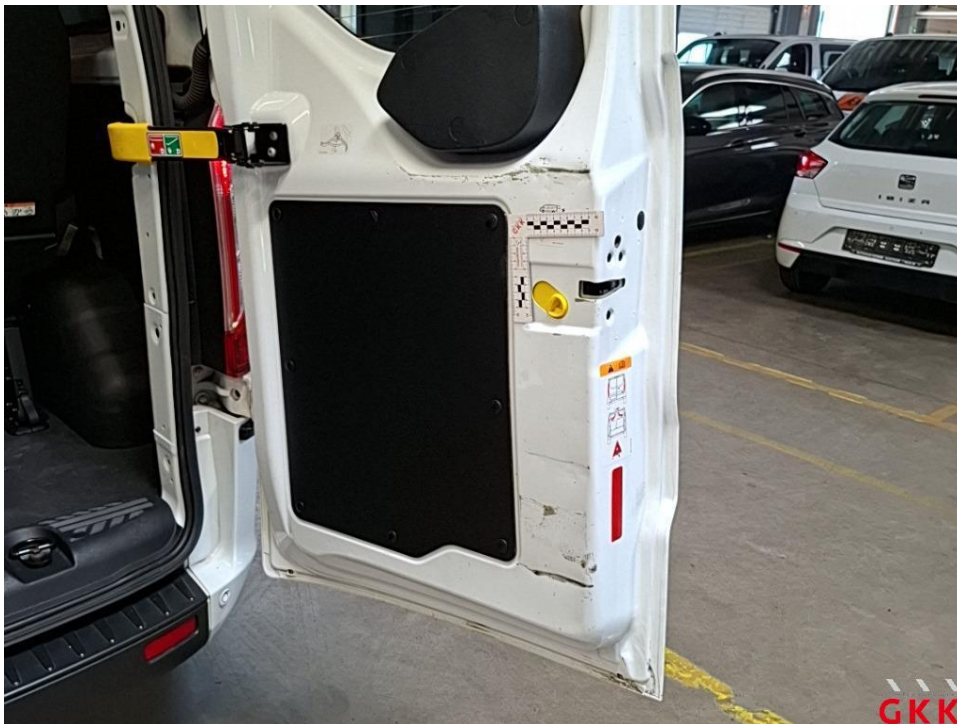
Bild 30 Hecktür rechts, innen, beschädigt, instand setzen - lackieren
