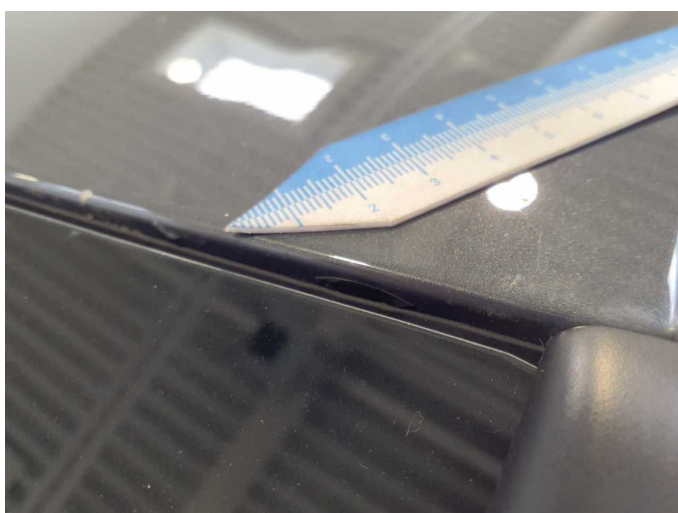
Damage 8: Roof: Roof (Scheibe nicht fachgerecht getauscht) - Paint defect - Repair and paint
