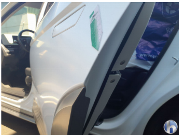
3. Tür Vorne - Rechts Lackabplatzer - Smart Repair
