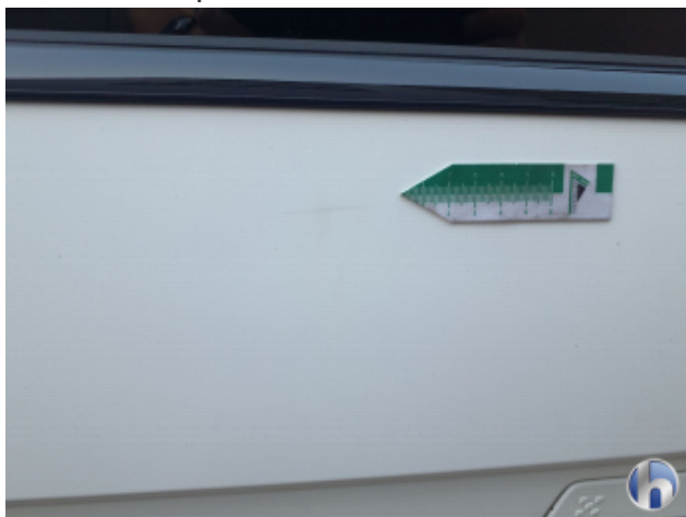
2. Tür Hinten - Links Oberflächenkratzer - Aufbereiten / Polieren
