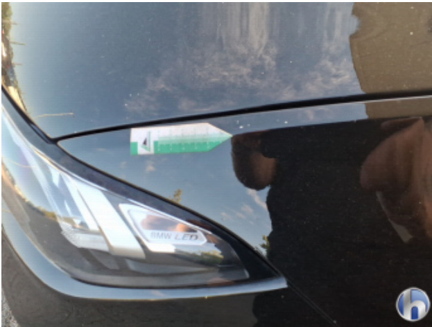
3. Kotflügel Vorne - Links Steinschlag - Lackieren
