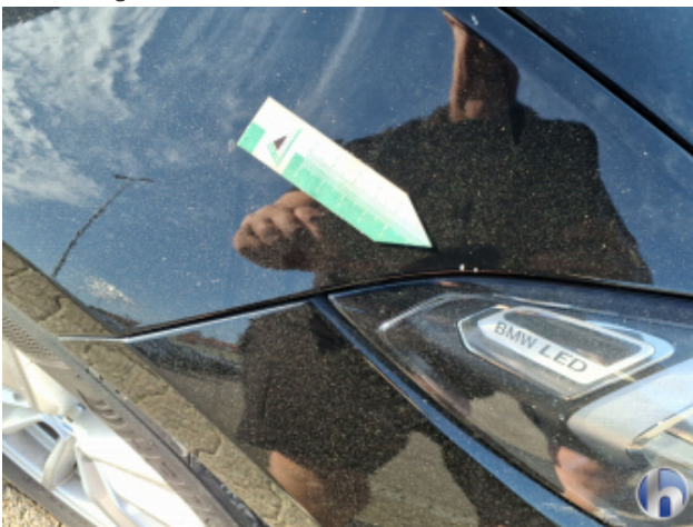
4. Kotflügel Vorne - Rechts Steinschlag - Lackieren
