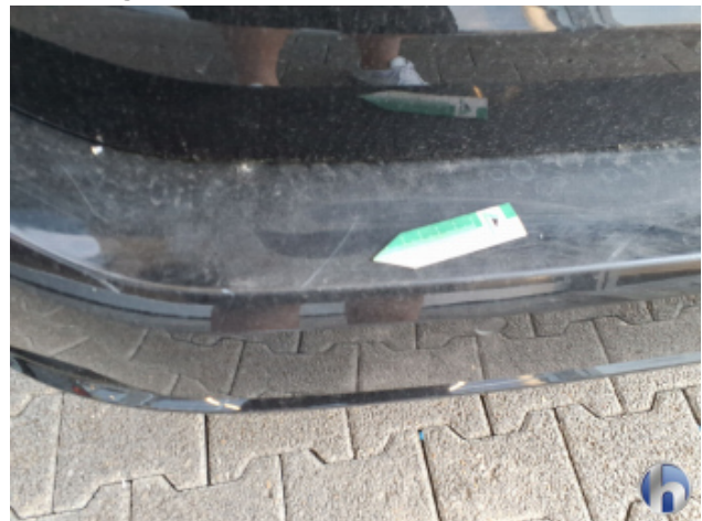
5. Stoßfänger Hinten Kratzer - Smart Repair
