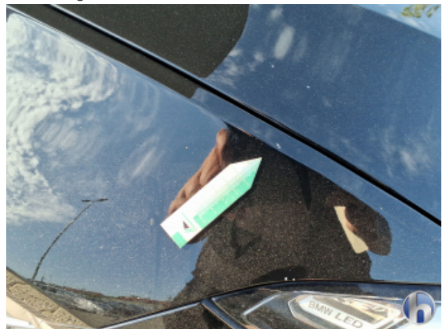
4. Kotflügel Vorne - Rechts Steinschlag - Lackieren
