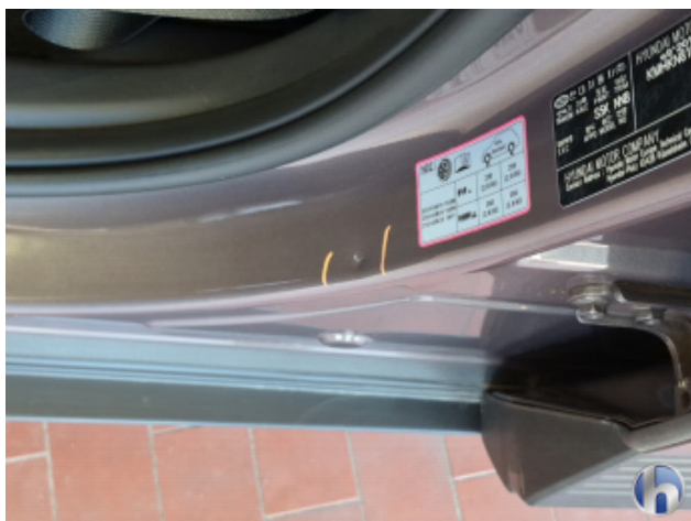
2. Türeinstieg Vorne - Links 1 Delle - Sanft Instandsetzen
