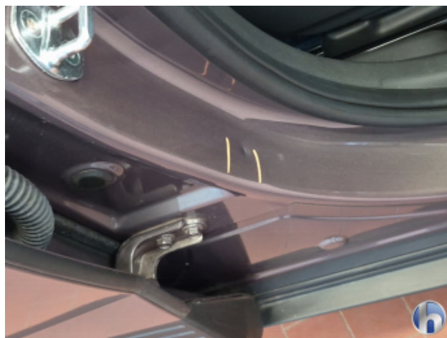
3. Türeinstieg Vorne - Rechts 1 Delle - Sanft Instandsetzen
