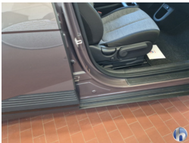
3. Türeinstieg Vorne - Rechts 1 Delle - Sanft Instandsetzen
