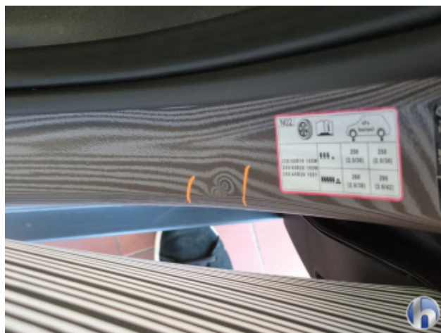
2. Türeinstieg Vorne - Links 1 Delle - Sanft Instandsetzen
