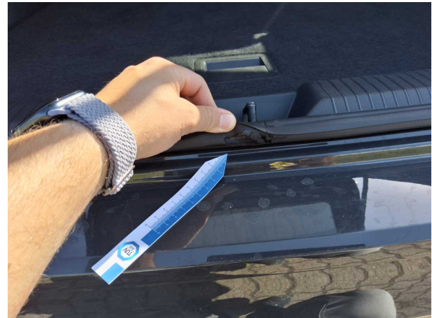
Beschädigung #3: Heckklappe/-tür: Dichtung - beschädigt - erneuern
