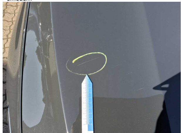
Beschädigung #6: Motorhaube: Motorhaube - Kratzer - lackieren
