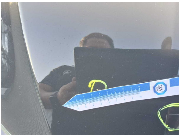
Beschädigung #6: Motorhaube: Motorhaube - Kratzer - lackieren
