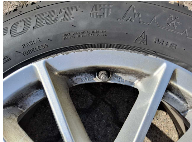
Beschädigung #5: 2.Radsatz: 1 Leichtmetallfelge - beschädigt - erneuern
