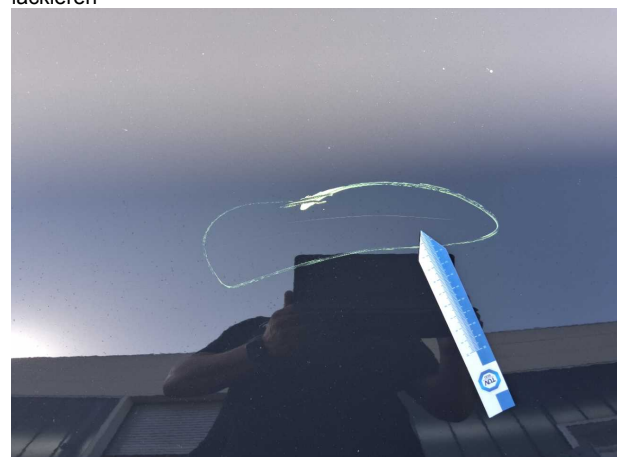
Beschädigung #6: Motorhaube: Motorhaube - Kratzer - lackieren
