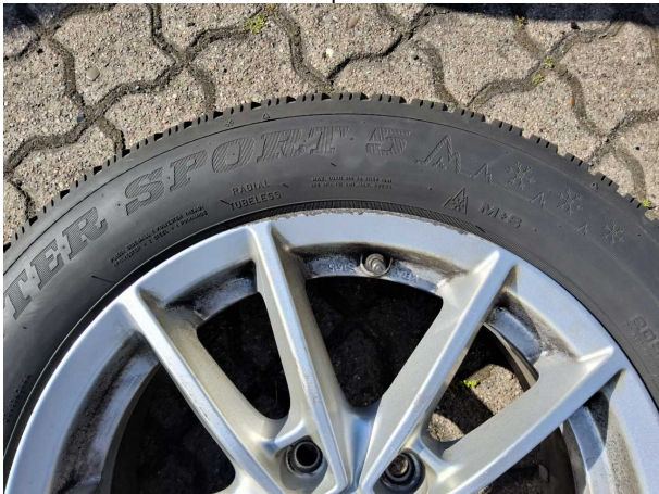
Beschädigung #5: 2.Radsatz: 1 Leichtmetallfelge - beschädigt - erneuern
