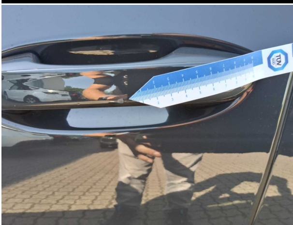
Beschädigung #2: Tür vorn links: Griff außen - Delle / Lackschaden - Smart Repair
