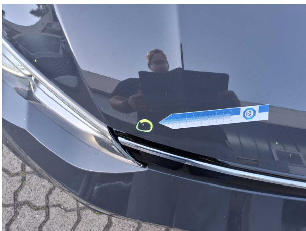
Beschädigung #6: Motorhaube: Motorhaube - Kratzer - lackieren
