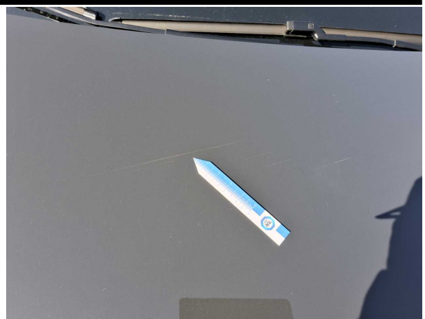
Beschädigung #6: Motorhaube: Motorhaube - Kratzer - lackieren
