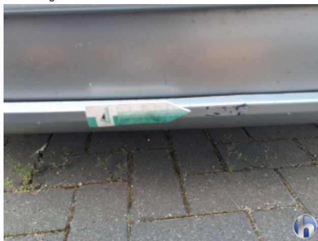
1. Stoßfänger Vorne Beschädigt - Lackieren
