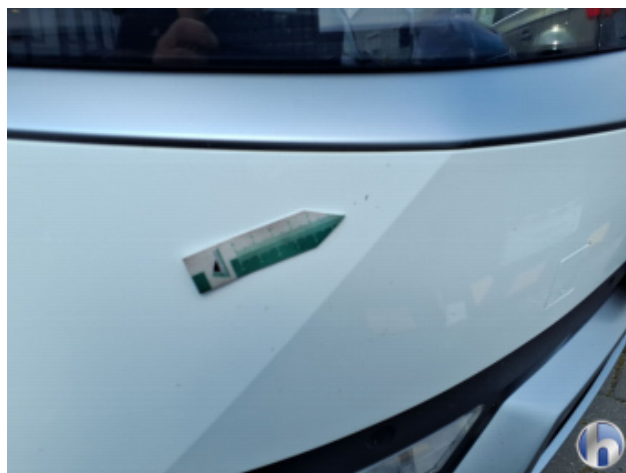
1. Stoßfänger Vorne Beschädigt - Lackieren
