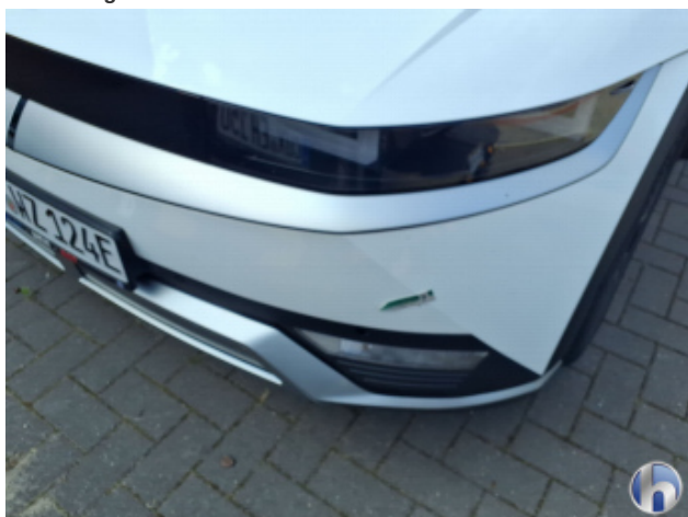
1. Stoßfänger Vorne Beschädigt - Lackieren
