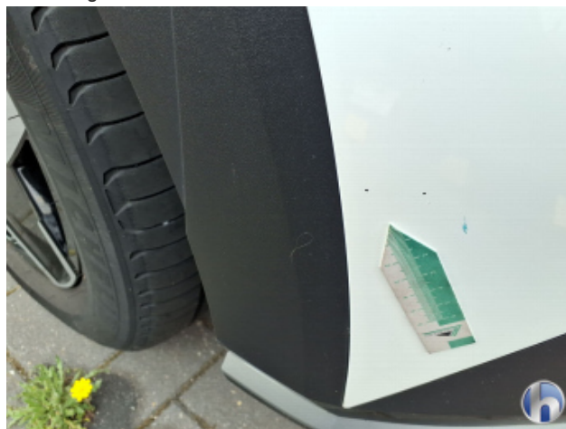
1. Stoßfänger Vorne Beschädigt - Lackieren
