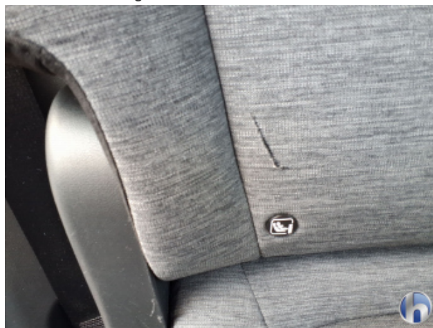
7. Sitz Innenraum rechts hinten Riss - Erneuern
