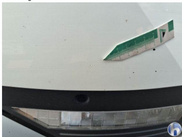
1. Stoßfänger Vorne Beschädigt - Lackieren
