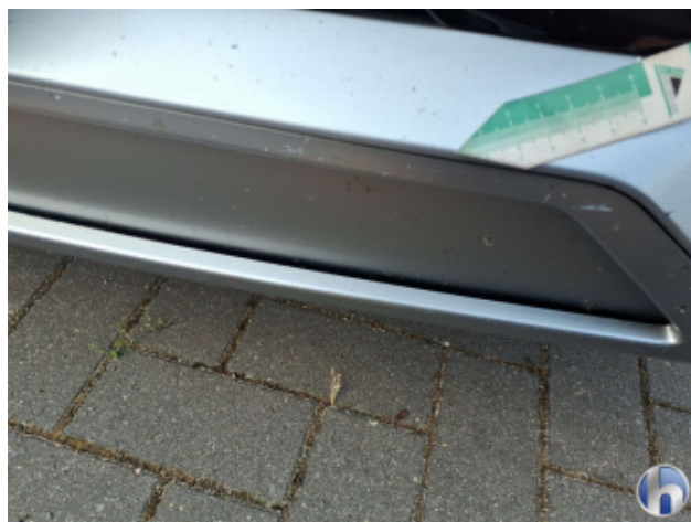
1. Stoßfänger Vorne Beschädigt - Lackieren
