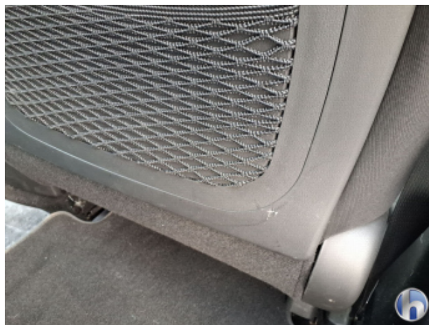
8. Sitz Innenraum rechts vorne Kratzer - Erneuern
