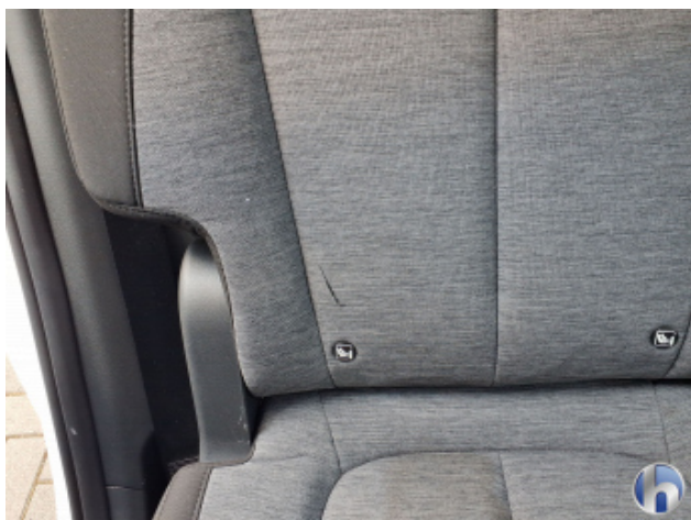
7. Sitz Innenraum rechts hinten Riss - Erneuern
