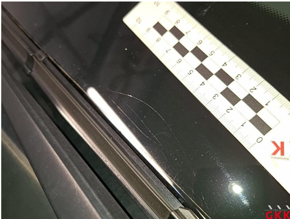
Bild 20 Frontscheibe, verkratzt, ersetzen
