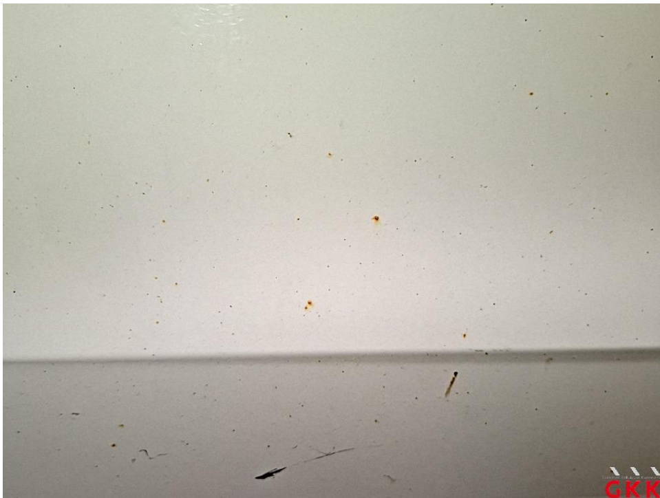
Bild 16 Fahrzeug, außen, Lackierung verwittert / matt, aufbereiten
