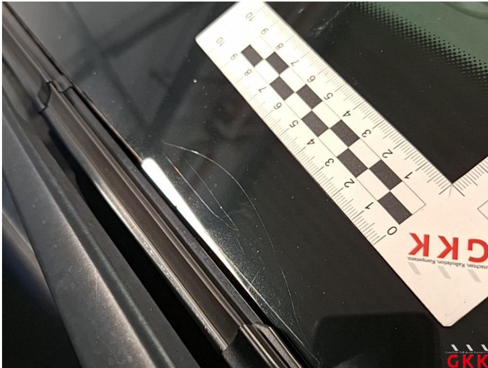
Bild 19 Frontscheibe, verkratzt, ersetzen
