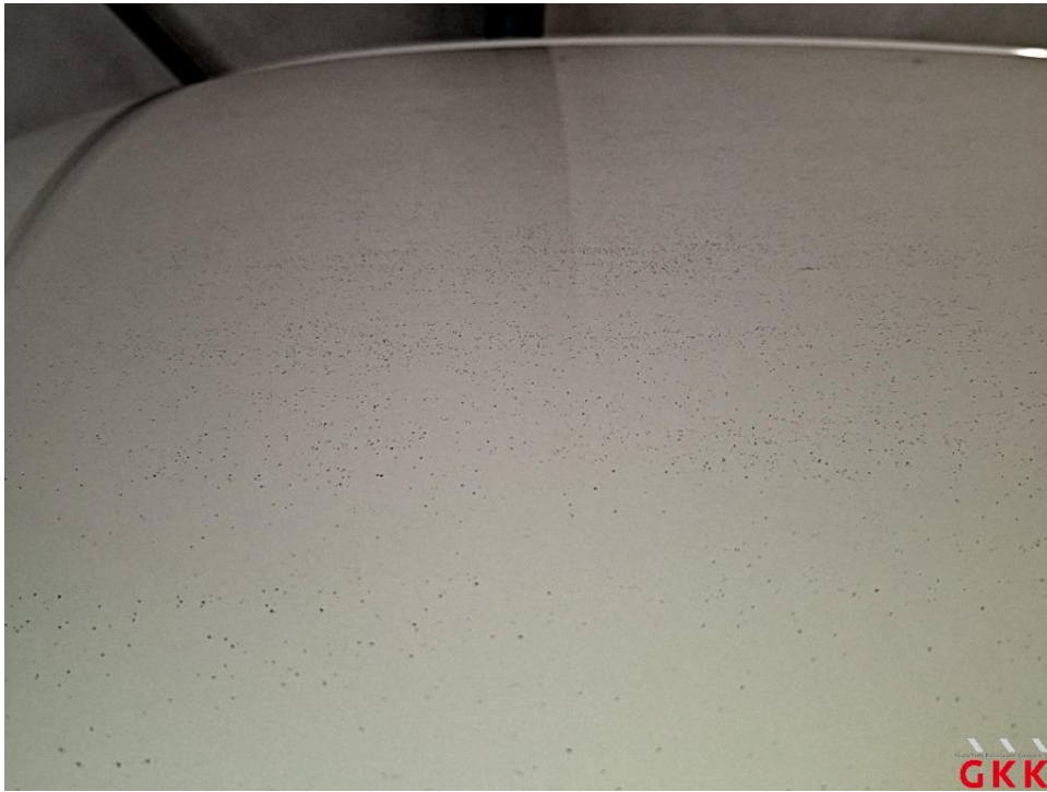
Bild 15 Fahrzeug, außen, Lackierung verwittert / matt, aufbereiten
