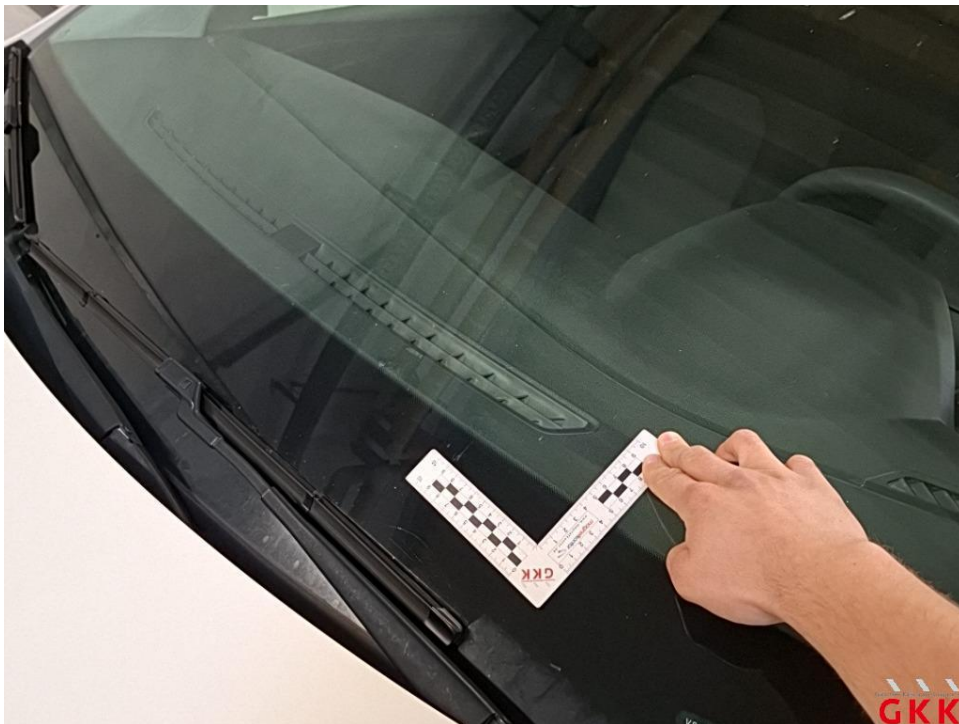
Bild 18 Frontscheibe, verkratzt, ersetzen
