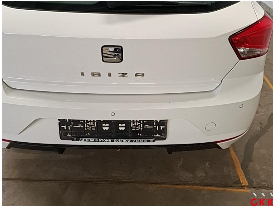
Bild 27 Stoßfänger hinten, Verkleidung -lackiert-, verkratzt, lackieren
