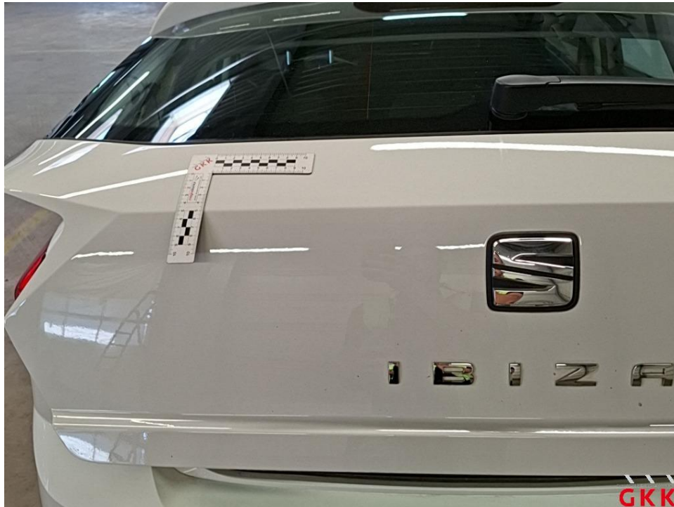
Bild 29 Heckklappe, beschädigt, kalt drücken
