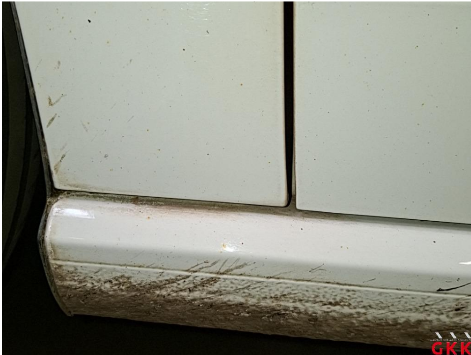
Bild 17 Fahrzeug, außen, Lackierung verwittert / matt, aufbereiten
