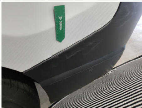
Seitenwand / Hinten Links / Delle
