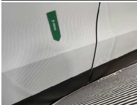
Seitenwand / Unten Hinten Rechts / Delle
