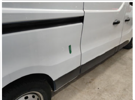
Seitenwand / Unten Hinten Rechts / Delle
