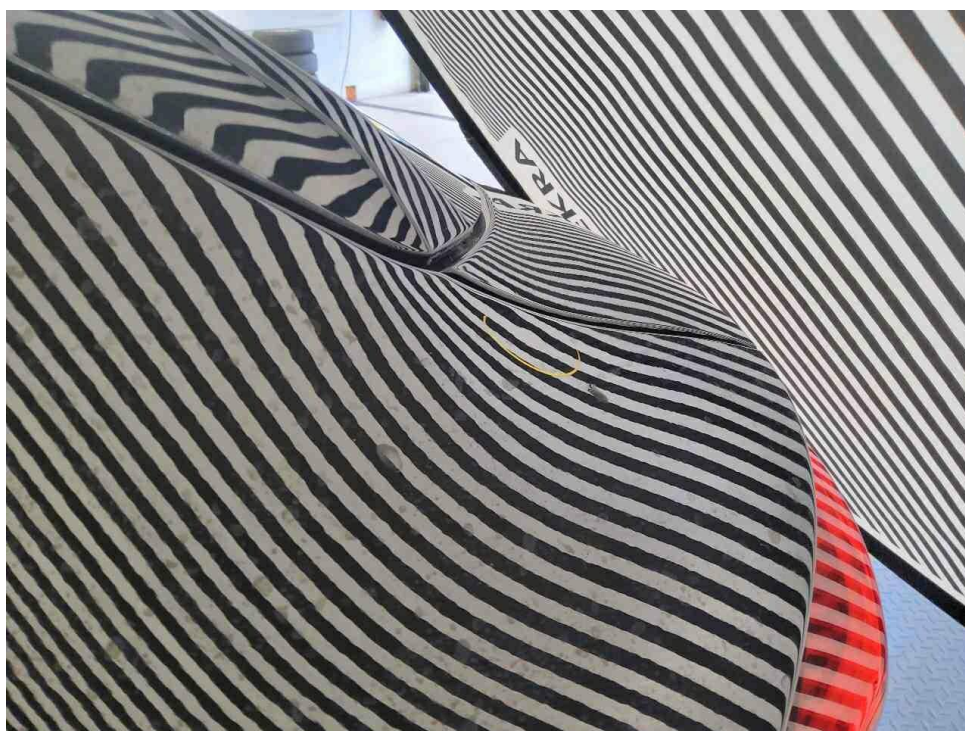
Bild 48 : Hagelschaden Seitenteil hinten links
