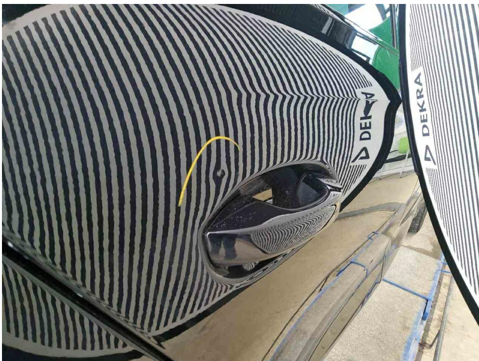
Bild 34 : Hagelschaden Tür hinten rechts
