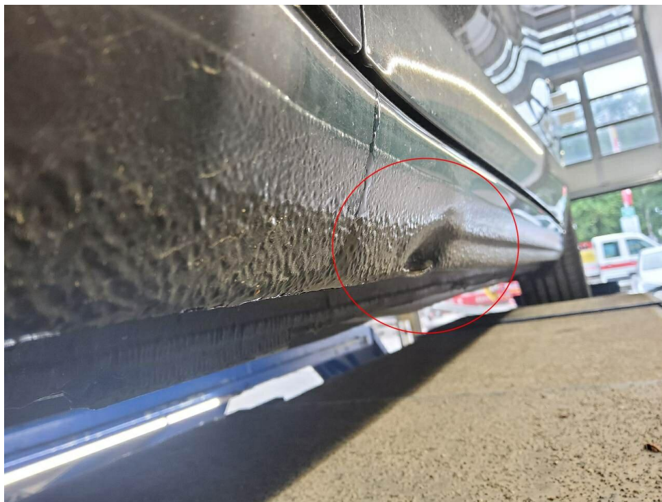
Bild 32 : Schweller links, gerissen
