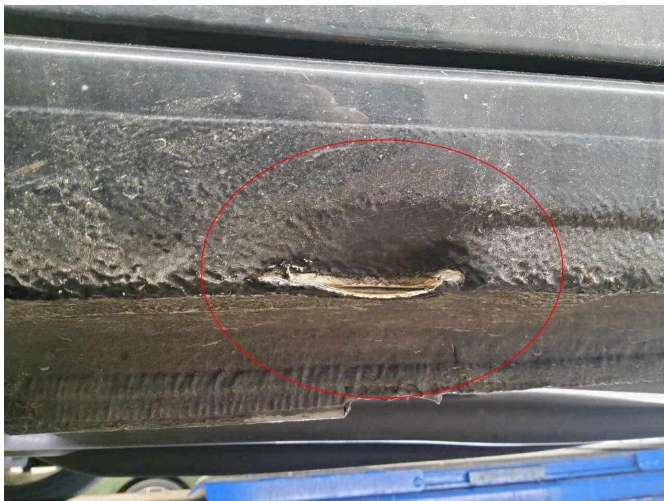
Bild 31 : Schweller links, gerissen
