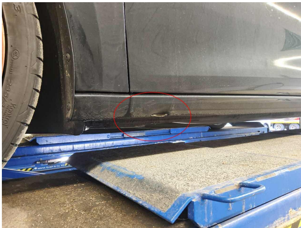
Bild 30 : Schweller links, gerissen
