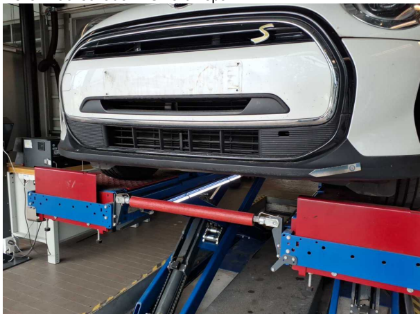
Beschädigung #9: Stossfänger vorn: Spoiler - verkratzt / verschürft - erneuern
