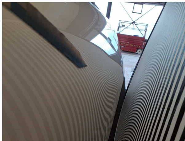
Beschädigung #4: Seitenwand links: Seitenwand - Delle(n) - sanft instandsetzen
