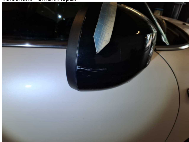
Beschädigung #2: Außenspiegel rechts: Abdeckkappe - verkratzt / verschürft - Smart Repair
