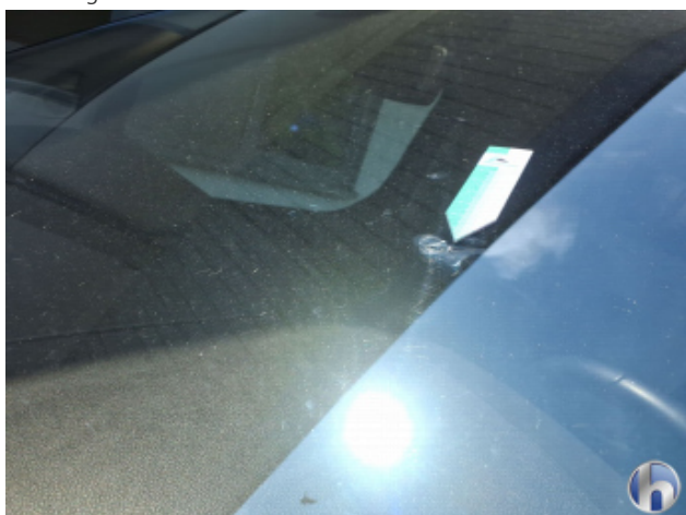
1. Windschutzscheibe Steinschlag - Smart Repair
