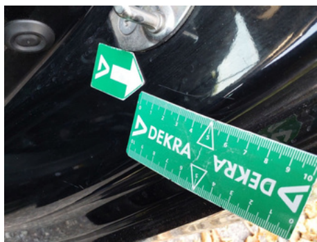
Entrée de porte / Arrière Gauche / Rayure
