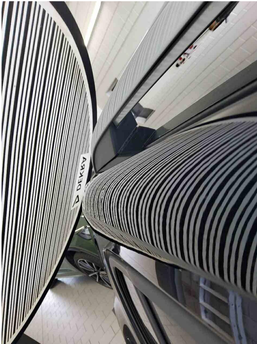
Bild 16 : Dachrahmen rechts Lackabplatzung und eingedellt
