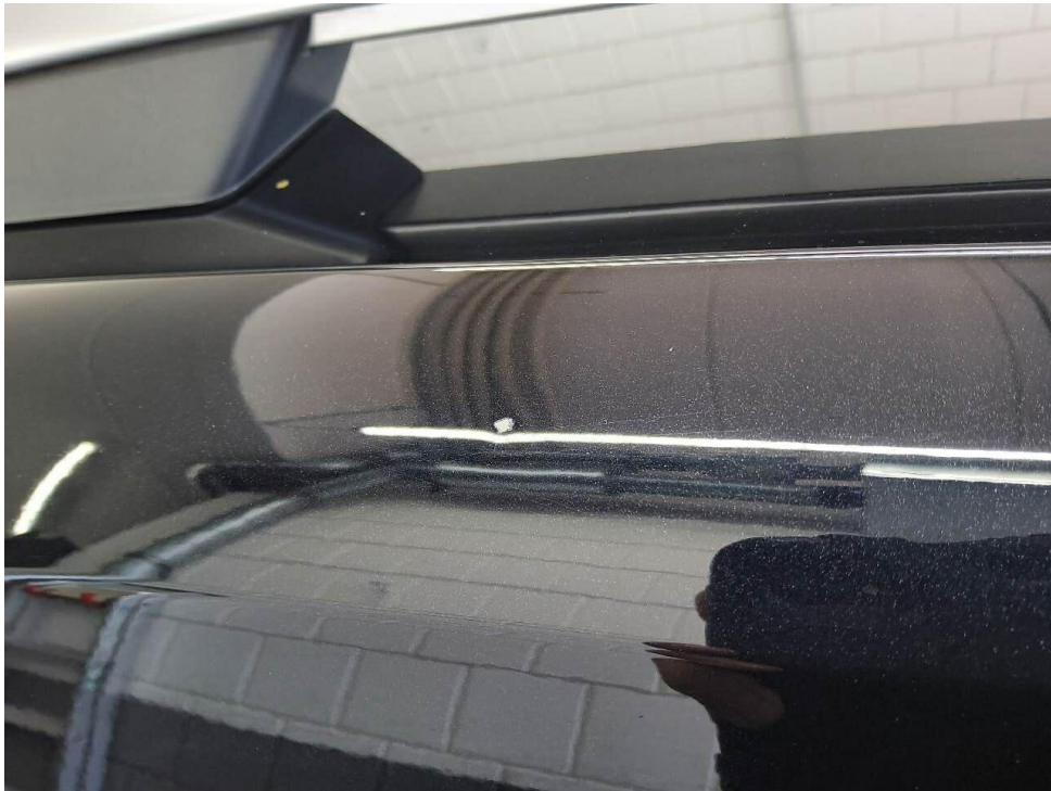
Bild 17 : Dachrahmen rechts Lackabplatzung und eingedellt
