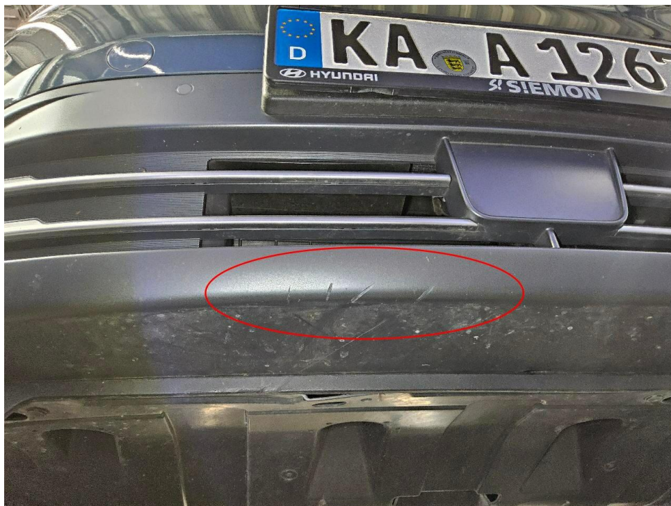
Bild 15 : Stoßfänger vorne unterhalb verkratzt
