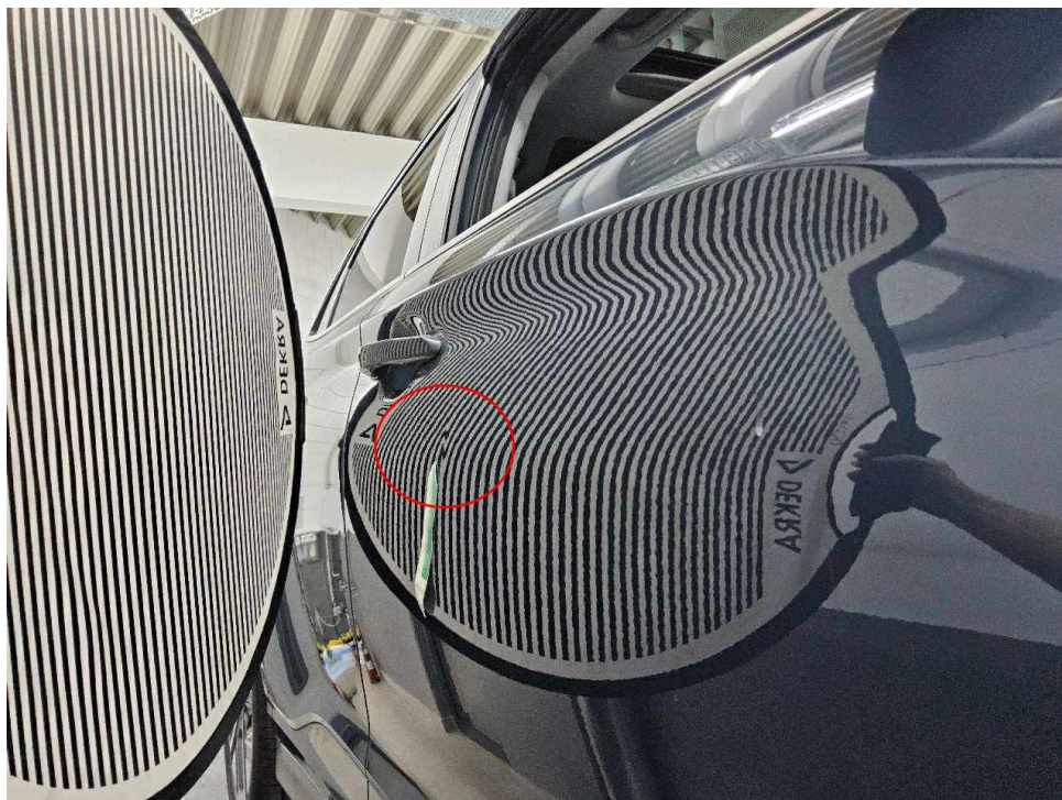
Bild 12 : Türe vorne rechts eingedellt
