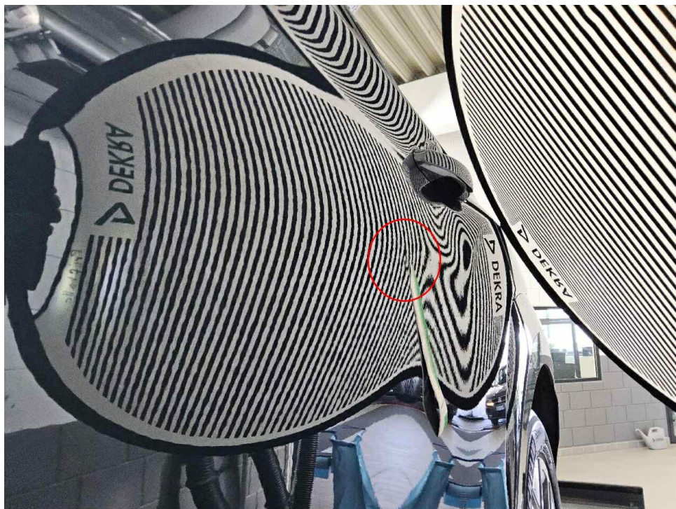
Bild 10 : Türe hinten links eingedellt
