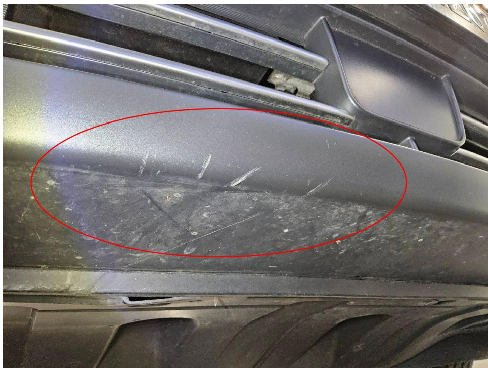
Bild 14 : Stoßfänger vorne unterhalb verkratzt
