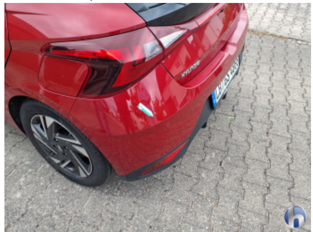
8. Stoßfänger Hinten Unsachgemäß Instandgesetzt - Lackieren
