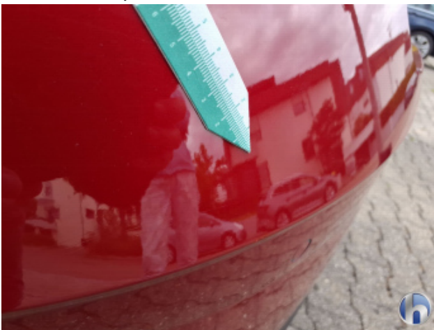
8. Stoßfänger Hinten Unsachgemäß Instandgesetzt - Lackieren
