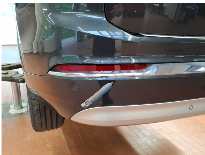
Damage 5: Rear bumper: Rear bumper (Stoßfänger Unten) - Scratch(es) - Paint
