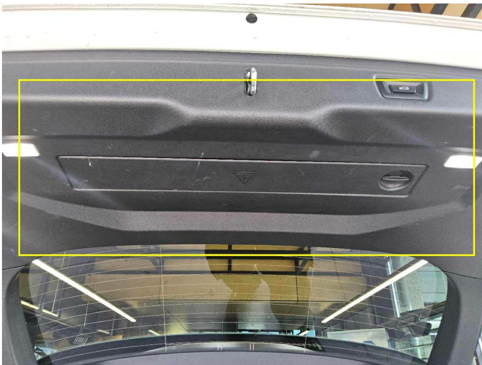
Bild 14 : Verkleidung Heckklappe verschrammt
