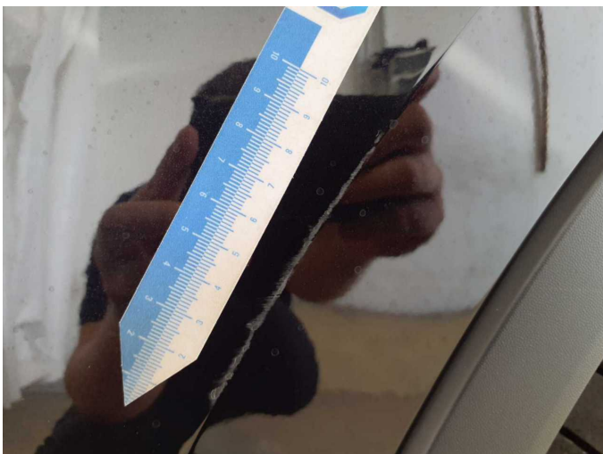
Damage 9: Front bumper: Front bumper (+ Radhausverbreiterung) - Scratch(es) - Paint
