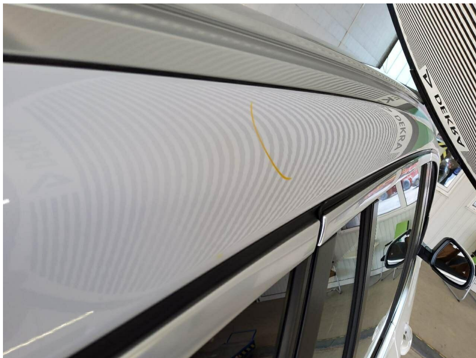
Bild 22 : Hagelschaden Dachrahmen rechts
