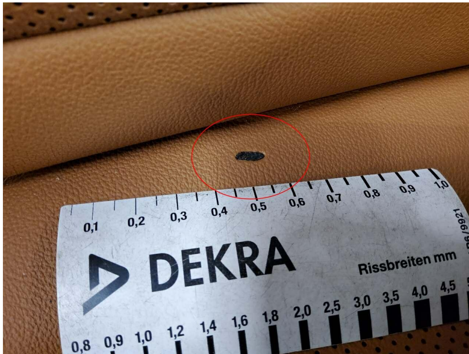
Bild 17 : Sitzbezug vorne rechts, beschädigt
