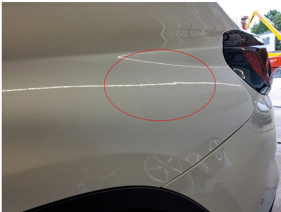
Bild 18 : Seitenteil hinten links, mehrfach eingedellt, instandsetzen und lackieren mit Lackaufbau
