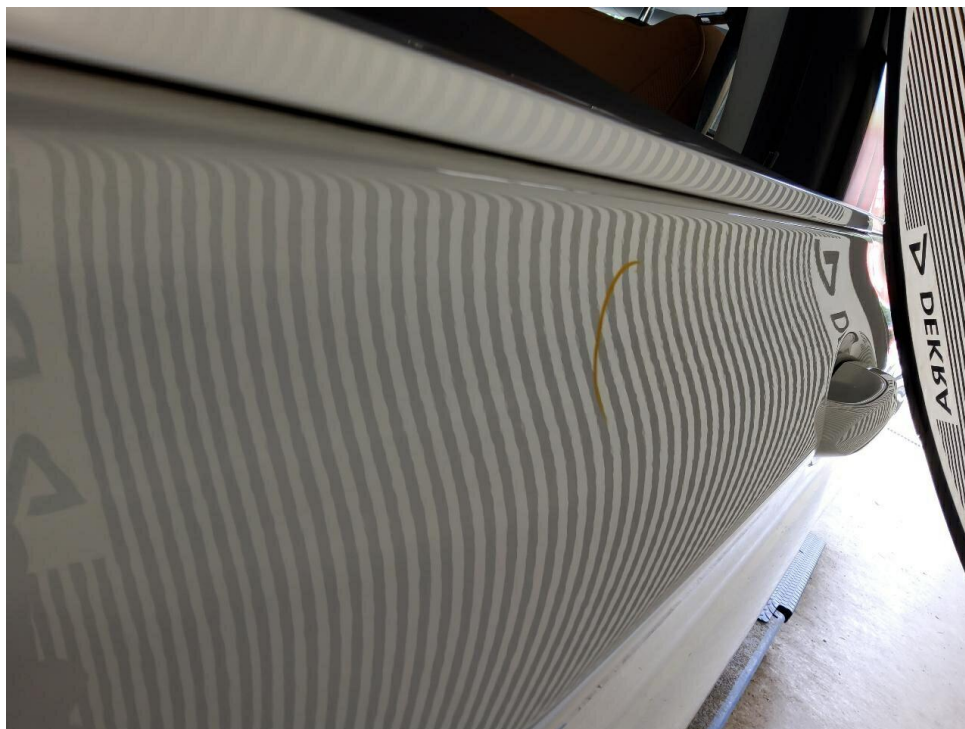
Bild 25 : Hagelschaden Tür hinten links
