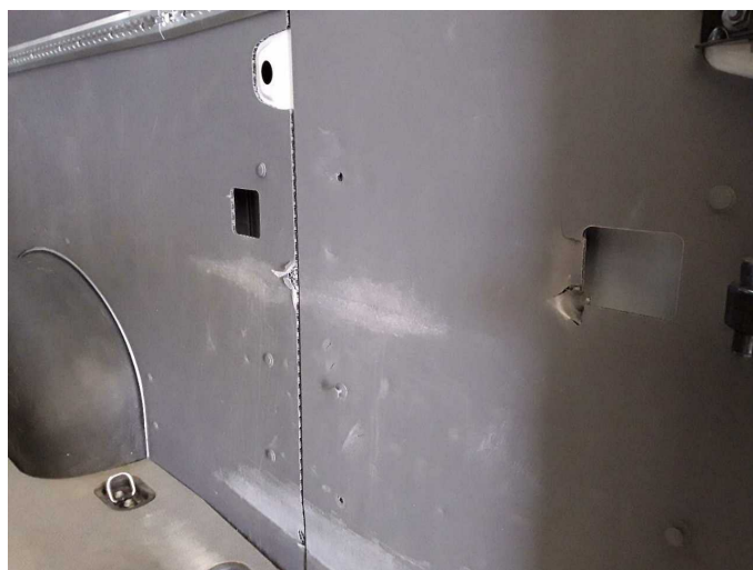
Damage 1: Interior: Interior (Laderaumverkleidungen) - Broken / torn - Replace
