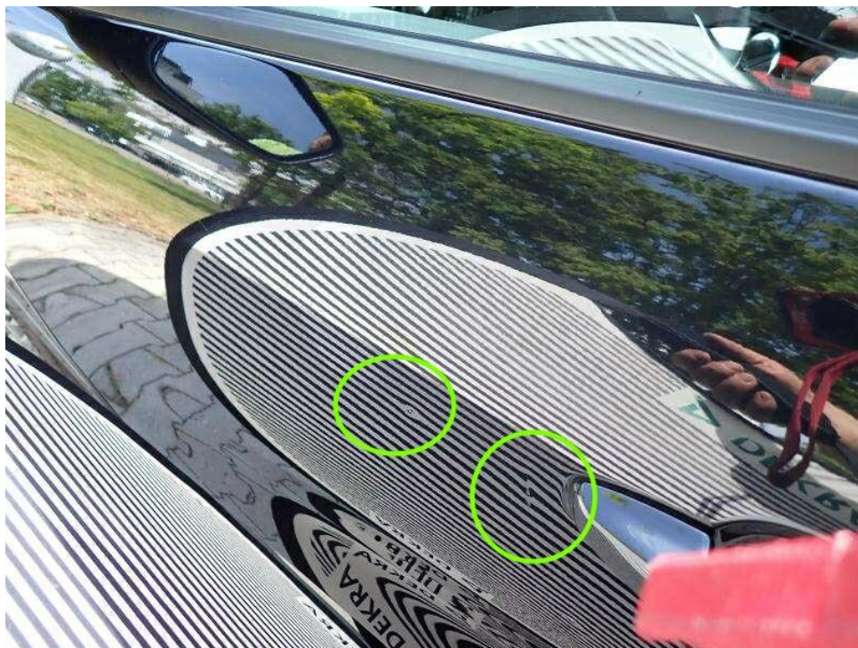
Bild 13 : Tür VL Delle Kratzer
