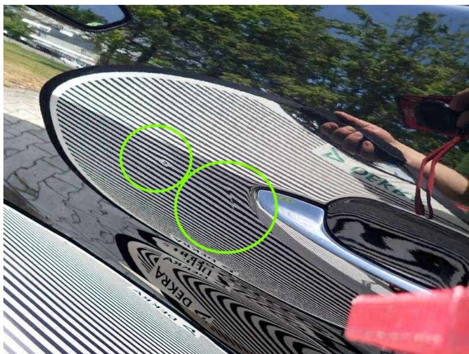
Bild 12 : Tür VL Delle Kratzer
