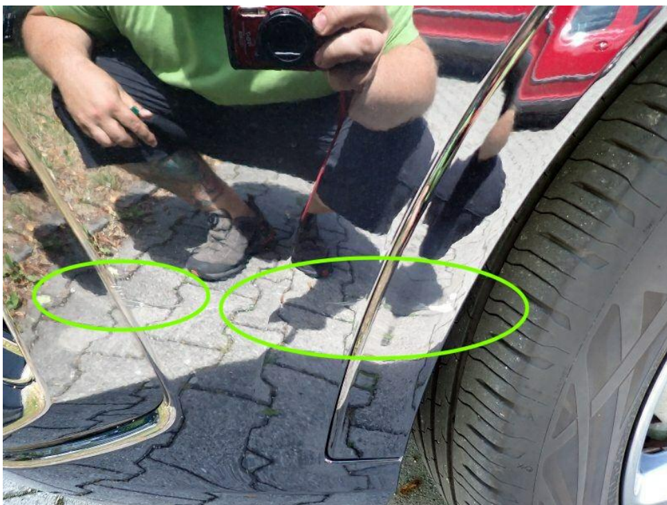
Bild 20 : Stoßfänger vorn Kratzer Radlaufblende VL Kratzer
