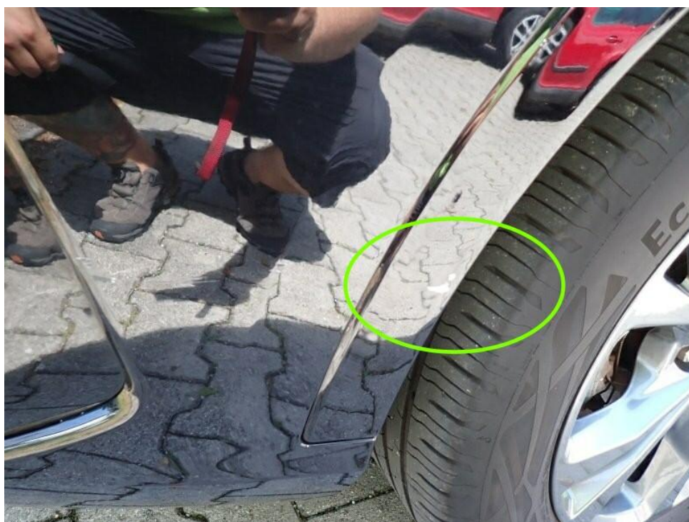
Bild 18 : Stoßfänger vorn Kratzer Radlaufblende VL Kratzer
