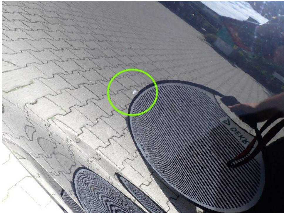
Bild 15 : Tür HR Delle Kratzer
