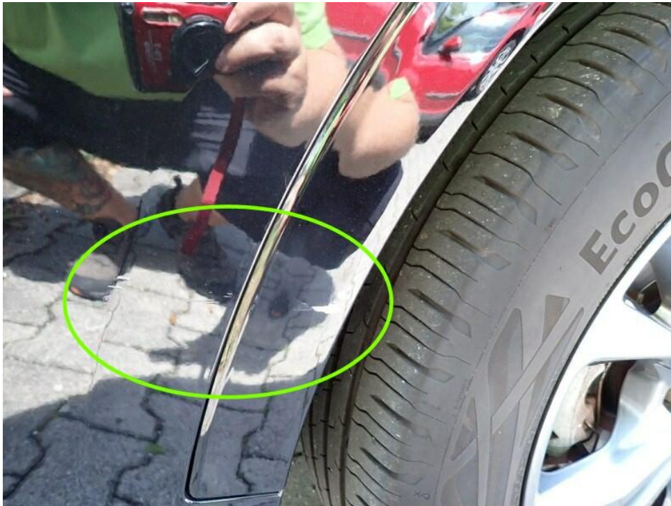
Bild 19 : Stoßfänger vorn Kratzer Radlaufblende VL Kratzer
