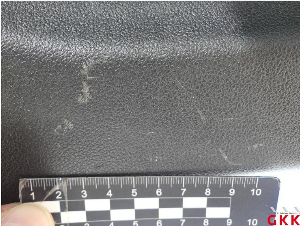
Bild 41. Heckklappe, Innenverkleidung, verkratzt, ersetzen
