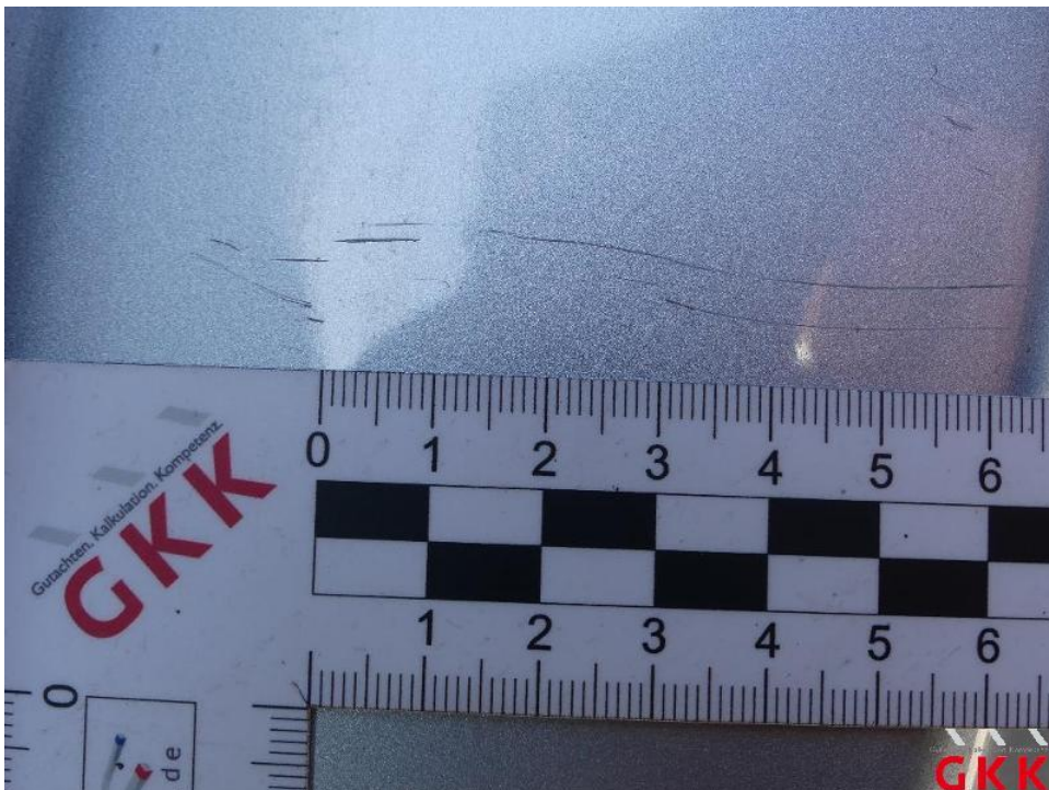
Bild 28. Tür hinten links, Einstieg, verkratzt, lackieren
