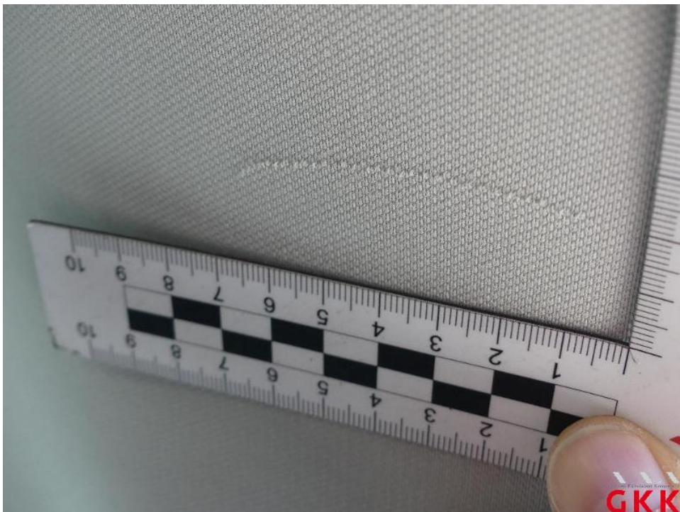
Bild 50. Himmel, hinten, beschädigt, Smartrepair
