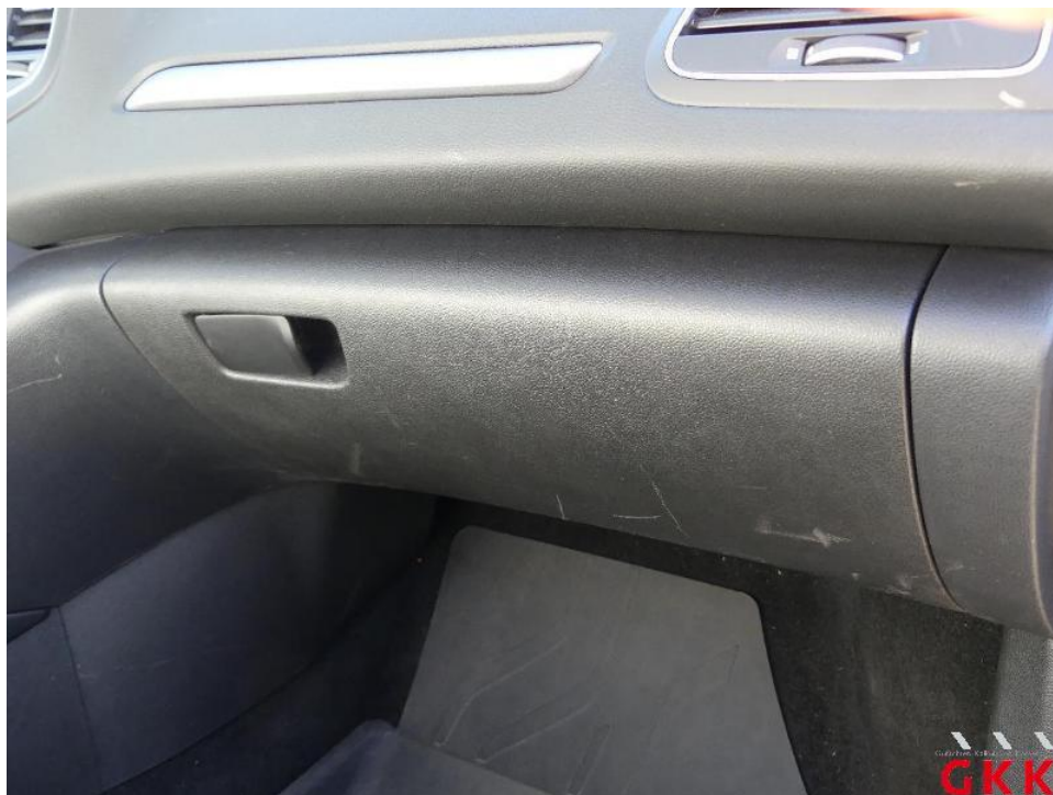
Bild 57. Handschuhfach, Deckel, verkratzt, ersetzen
