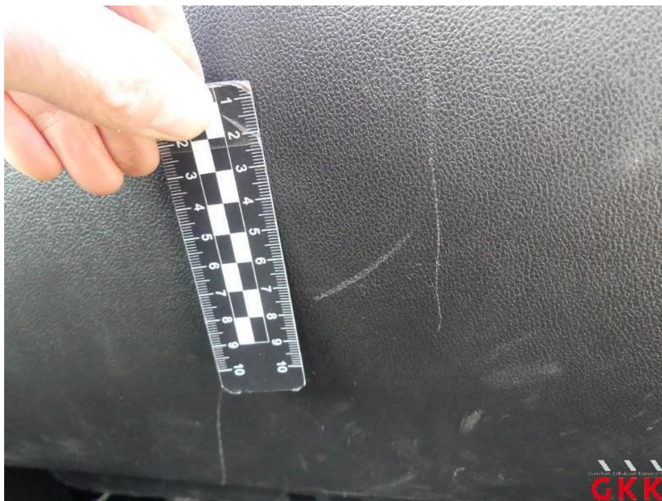
Bild 58. Handschuhfach, Deckel, verkratzt, ersetzen
