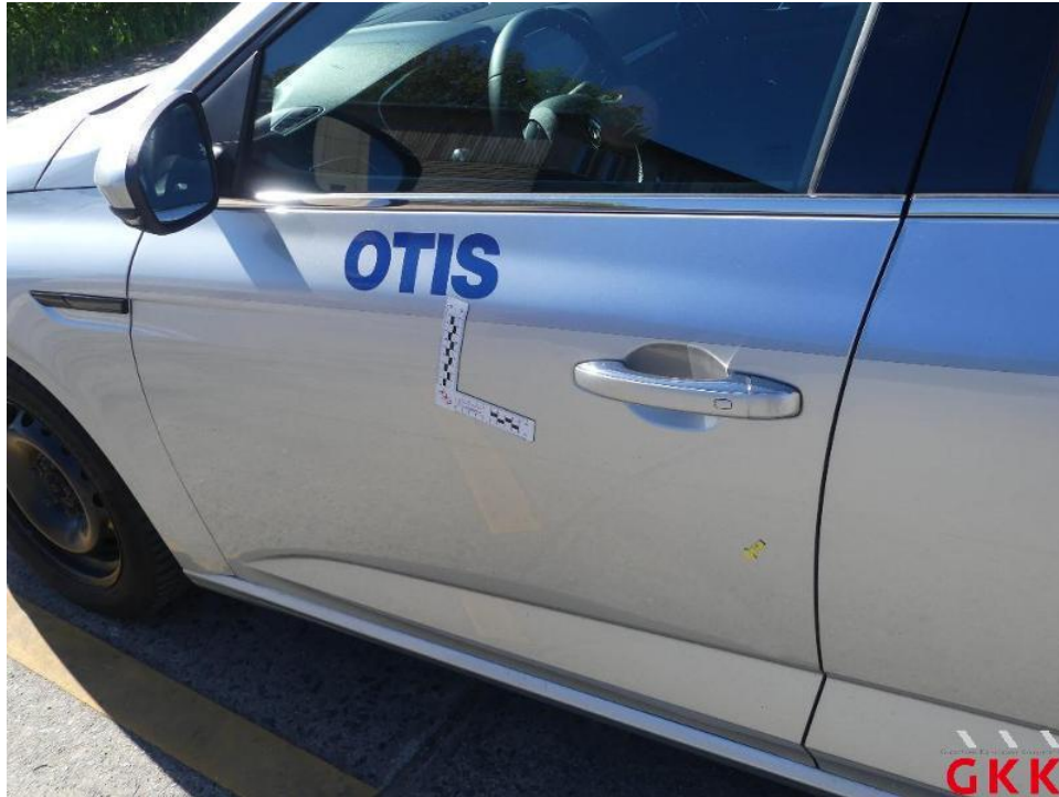
Bild 19. Tür vorne links, beschädigt, instand setzen - lackieren
