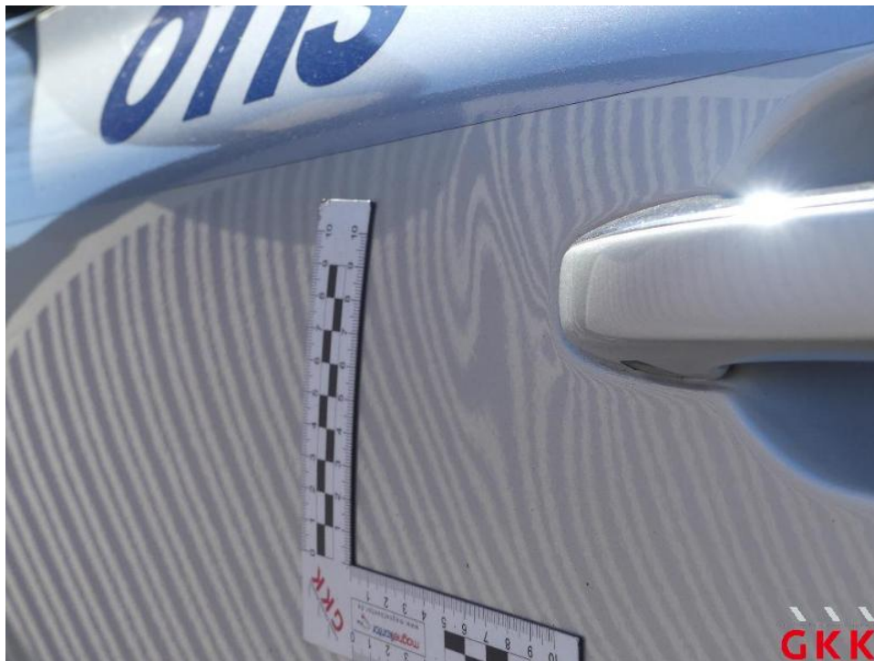
Bild 20. Tür vorne links, beschädigt, instand setzen - lackieren
